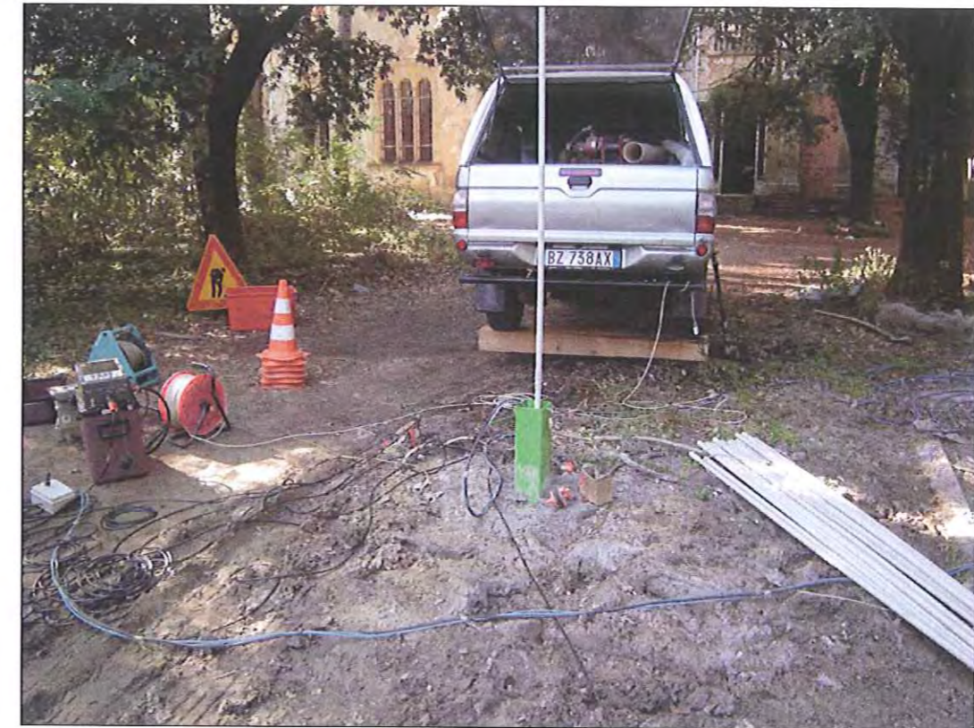
Downhole DHS1: allestimento delle attrezzature sul foro di sondaggio
