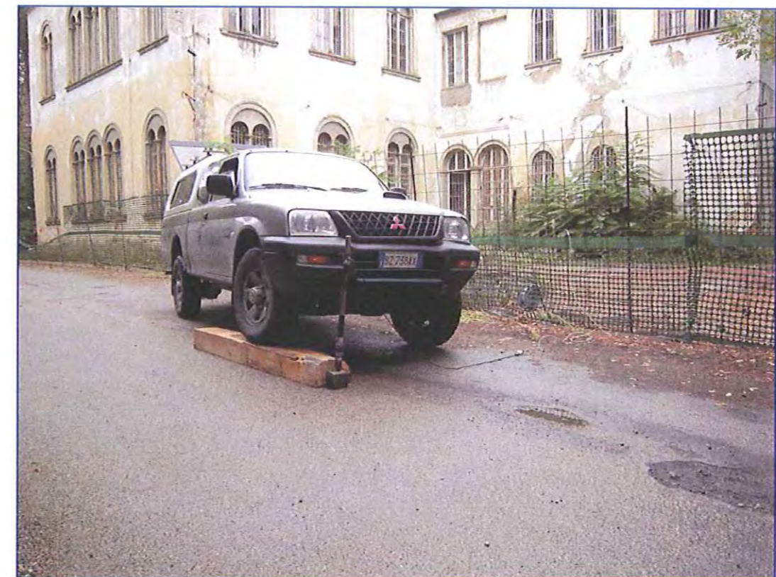
Profilo ST3: energizzazione onde SH su D2 = G6/7
