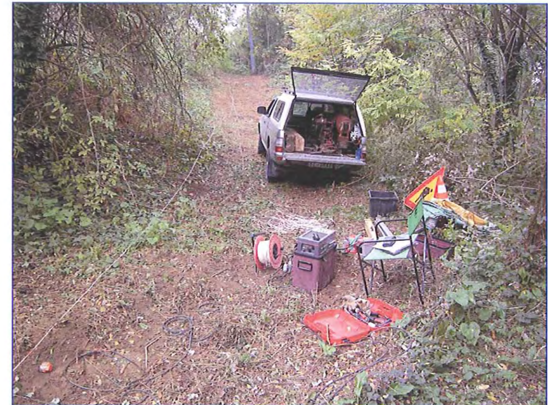
Profilo ST5: strumentazione utilizzata e particolare dello stendimento durante l'acquisizione con le onde SH
