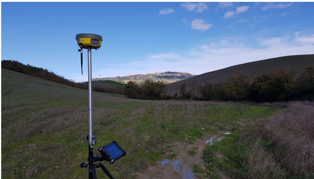
Ricevitore GNSS geodetico durante il rilievo di punti di appoggio in campo.
