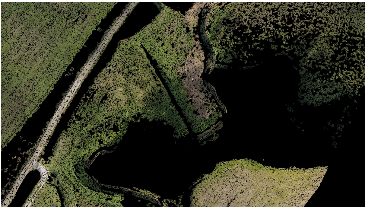
(Sopra) Fotografia area presa durante i voli fotogrammetrici di un'area boscata e (sotto) nuvola di punti rappresentativa dei punti del terreno da cui è stata rimossa la componente vegetazionale al suolo
