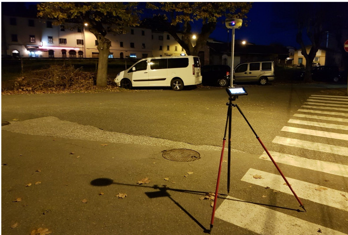
Rilievo di punti ben visibili al suolo per la valutazione esterna dell'accuratezza della restituzione
