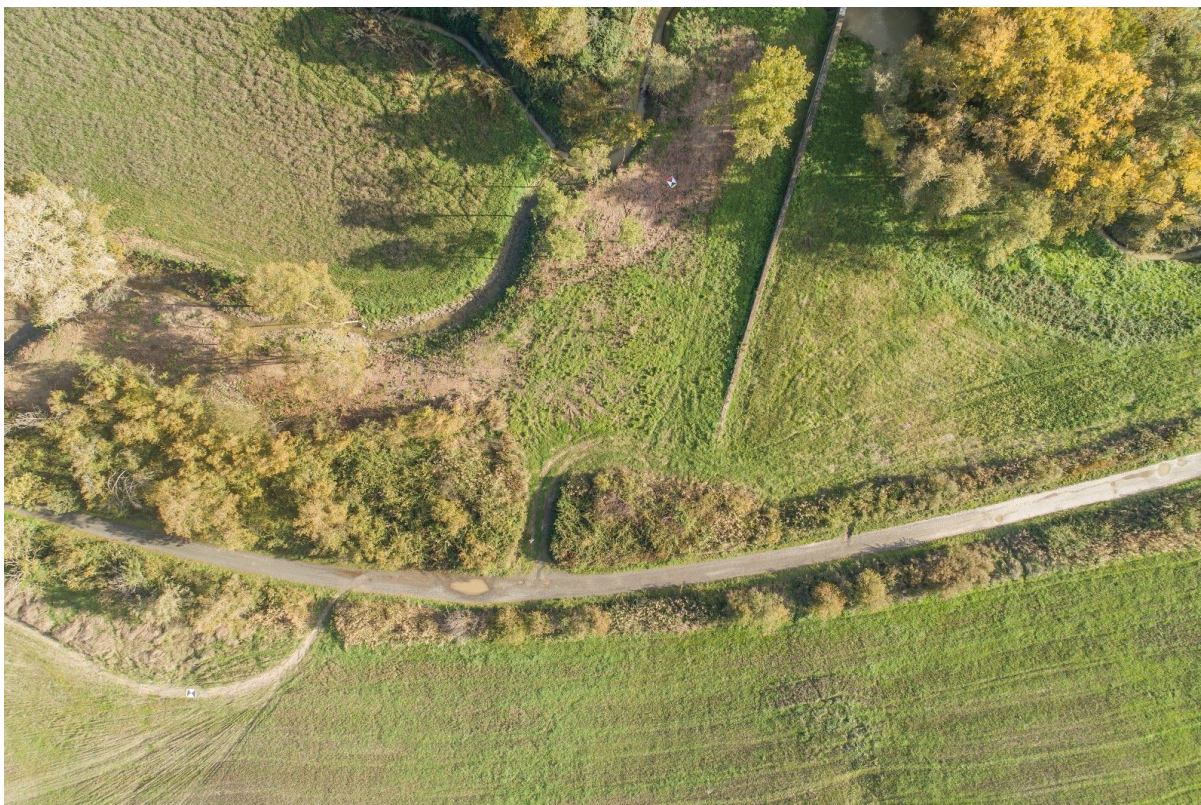
Fotogramma della presa aerea fotogrammetria dove sono presenti due punti di appoggio, le cui coordinate sono state rilevate con strumentazione topografica.
