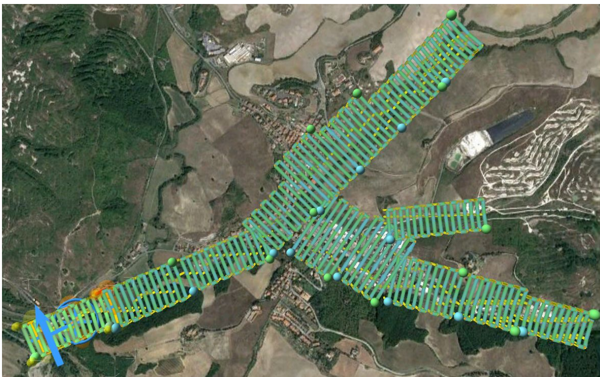
Missioni di volo automatico programmate ed eseguite per il rilievo dell'area di indagine
