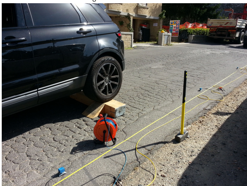
Sistema di energizzazione (traversina di legno - mazza battente - geofono trigger/starter)
