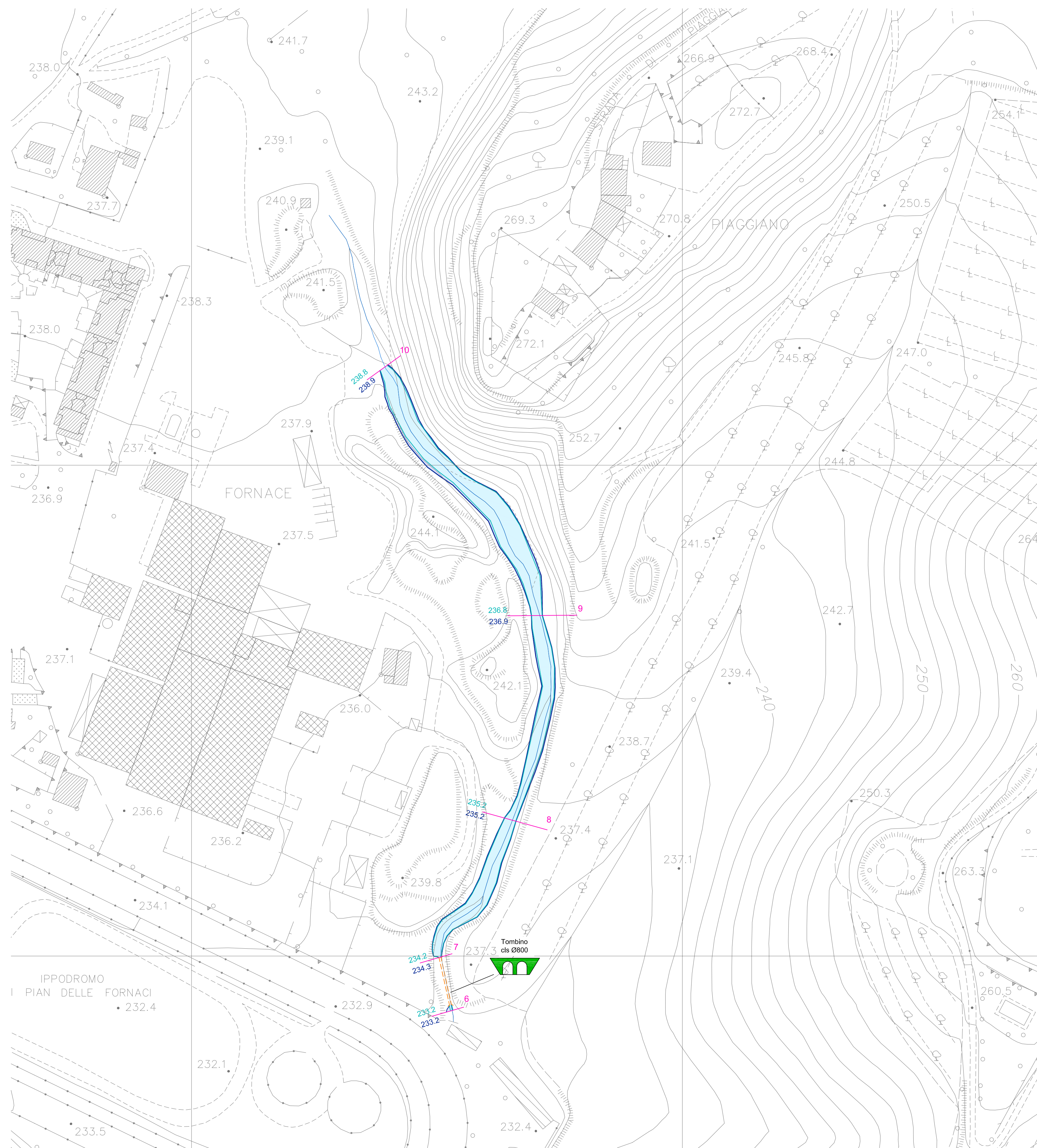
PLANIMETRIA AREE ALLAGATE AFFLUENTE IN SINISTRA T. SORRA IN ZONA 'PIAN DELLE FORNACI' ( Cartografia CTR 1:2000) 1:1000
