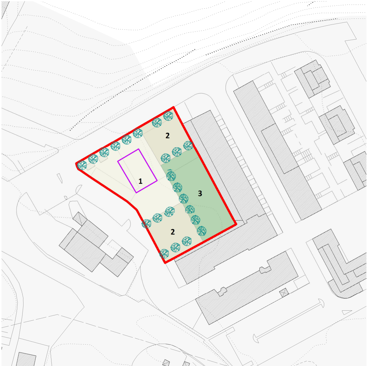
Schema di riferimento: 1 – area destinata alla nuova edificazione con sedime indicativo dei nuovi volumi (altezza massima 3 piani) 2 - parcheggio pubblico a raso alberato 3 - giardino pubblico
