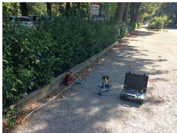
1 MASW 24 Stendimento di sismica attiva MASW
