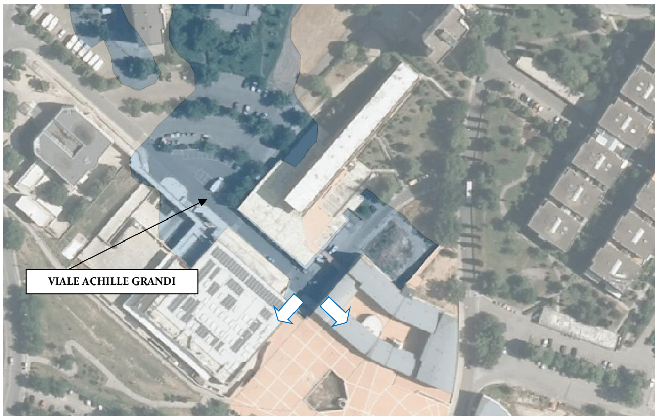
Figura 6.63 - Vista di Viale Achille Grandi e delle aree allagate per Tr200. Le frecce indicano le posizioni d'ingresso a parcheggi interrati.
