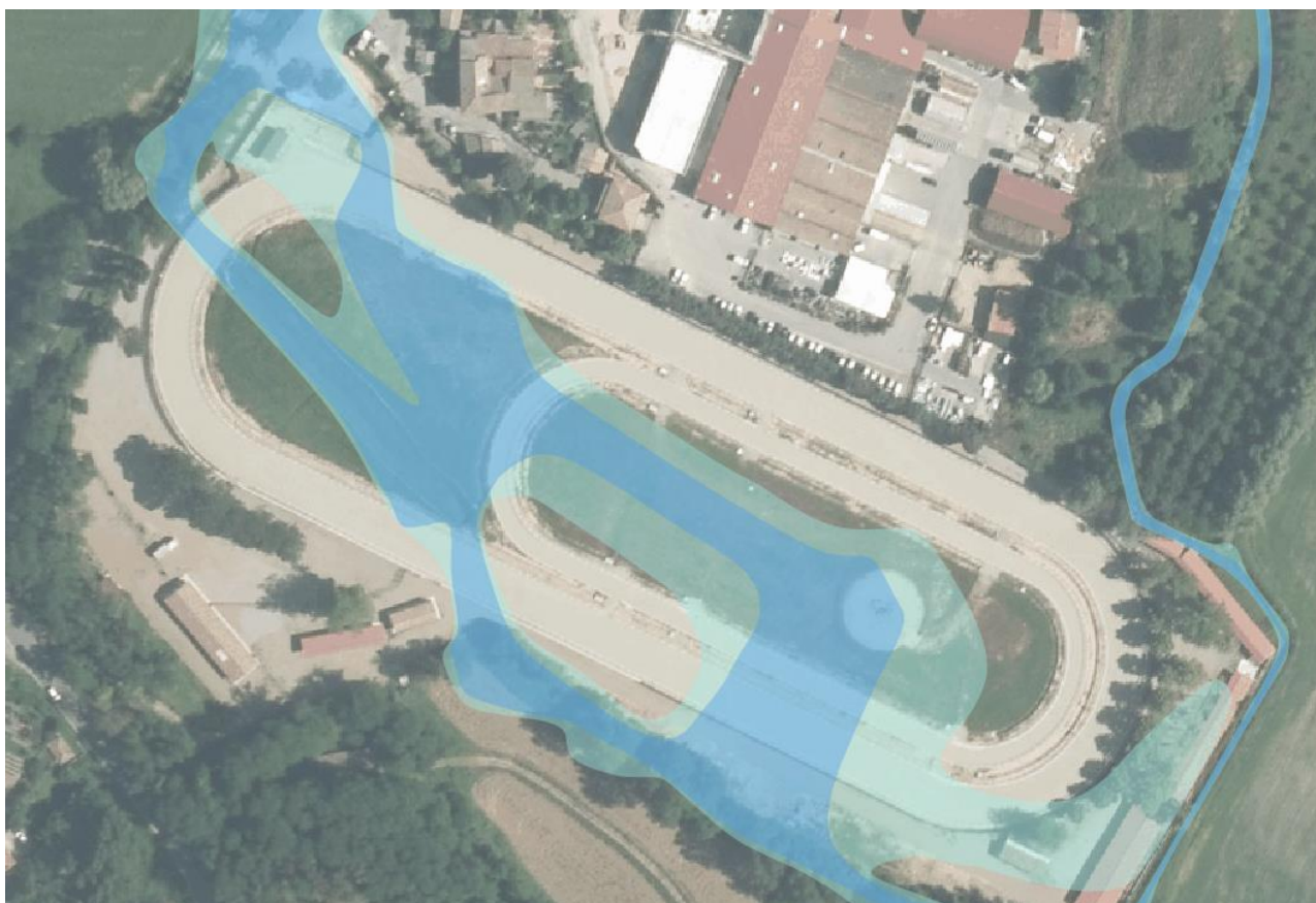
Figura 6.15 - Estratto della carta delle aree allagate per TR200 (celeste) e Tr30 (blu).
