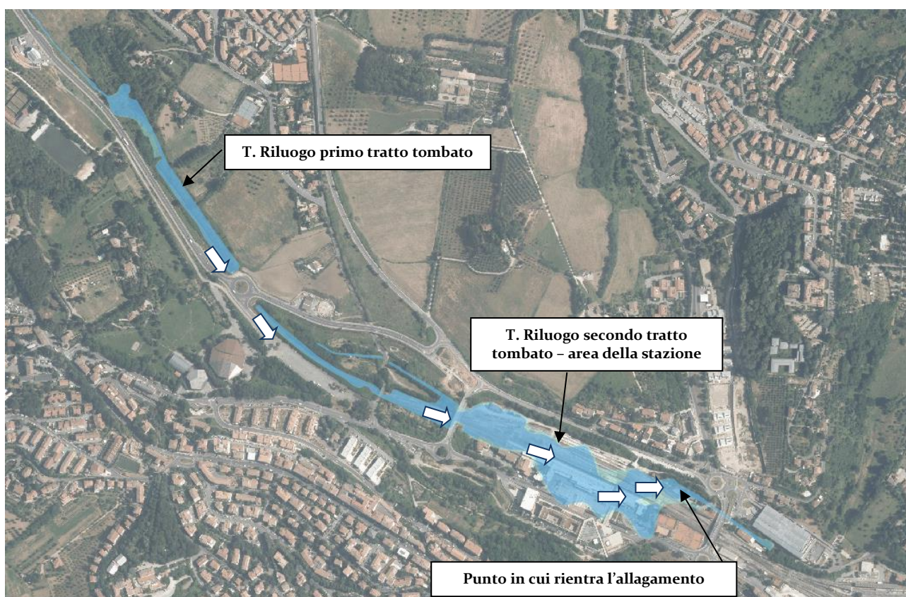
Figura 6.33 – Principali criticità idrauliche; l'area della stazione ferroviaria.
