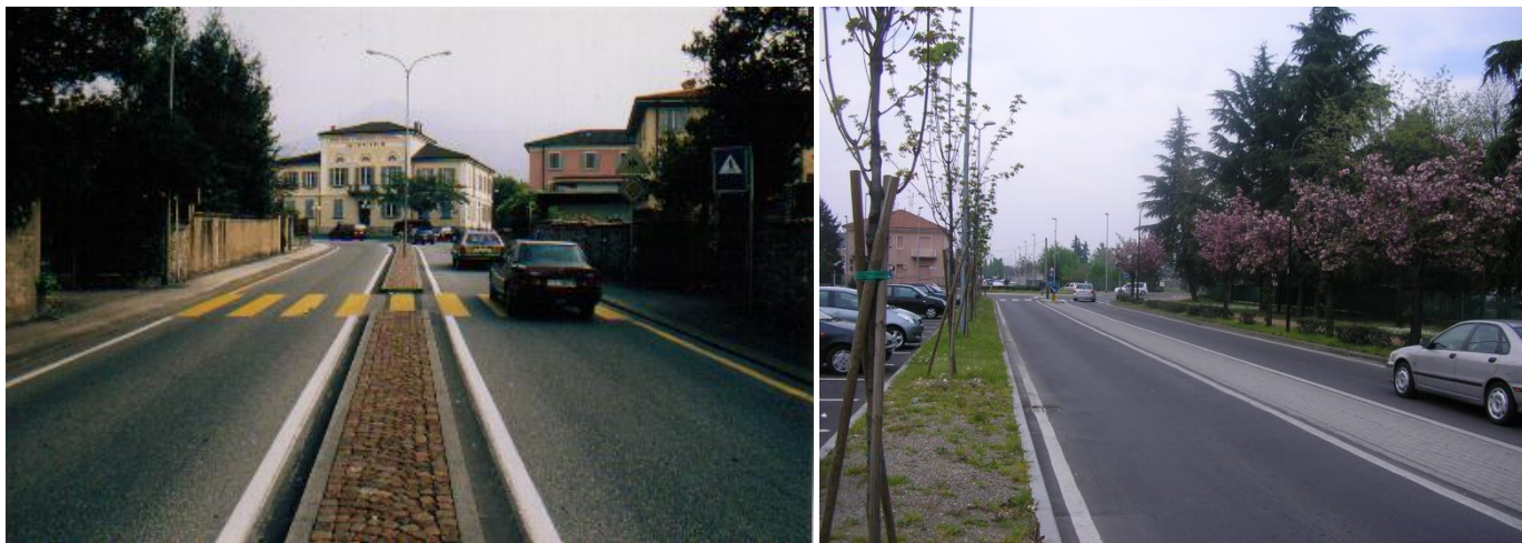
Esempi di bande centrali insormontabili o semisormontabili
