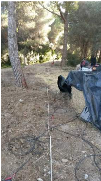
Foto n. 2: stendimento geofonico per acquisizione onde di Reyleigh.
