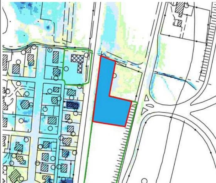
*Battenti Tr 200 in scenario di progetto con inserimento delle opere idrauliche di contenimento dei volumi esondati dal Fosso Cipressetti.*
