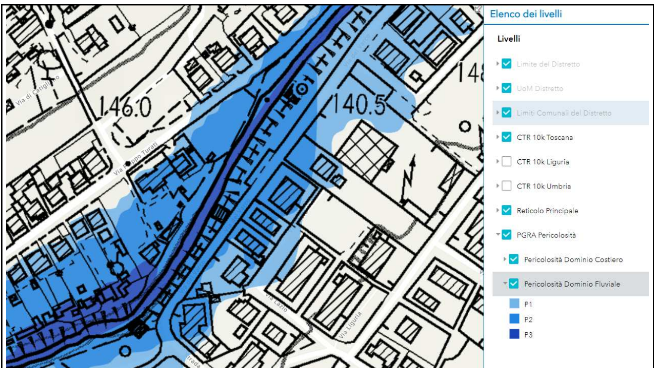
Particolare di perimetrazione pericolosità idraulica da PGRA
