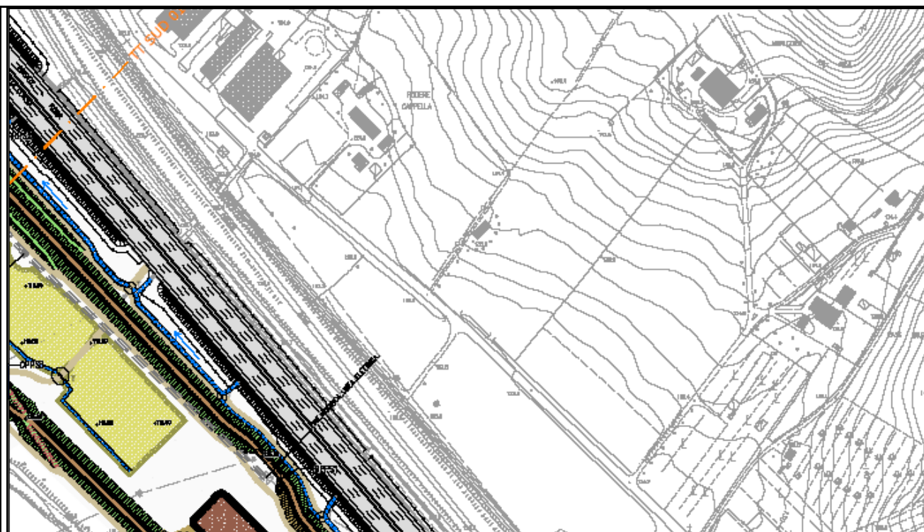
Particolare dell'elaborato di progetto con definizione della quota di "testa d'argine" a 125,85 m.s.l.m.
