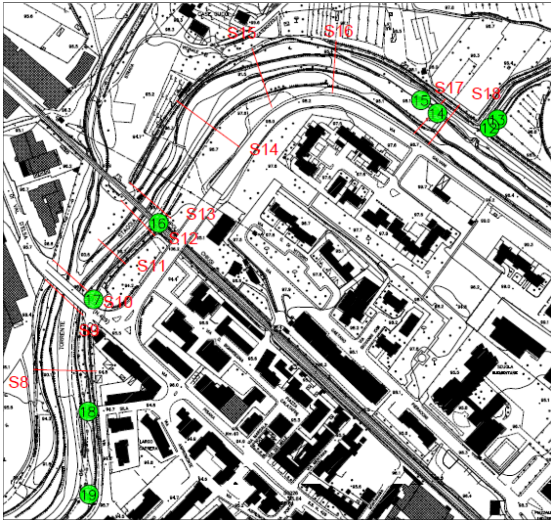
Fig. 51 – Scarichi rilevati lungo il tratto urbano del Torrente Staggia (1)
