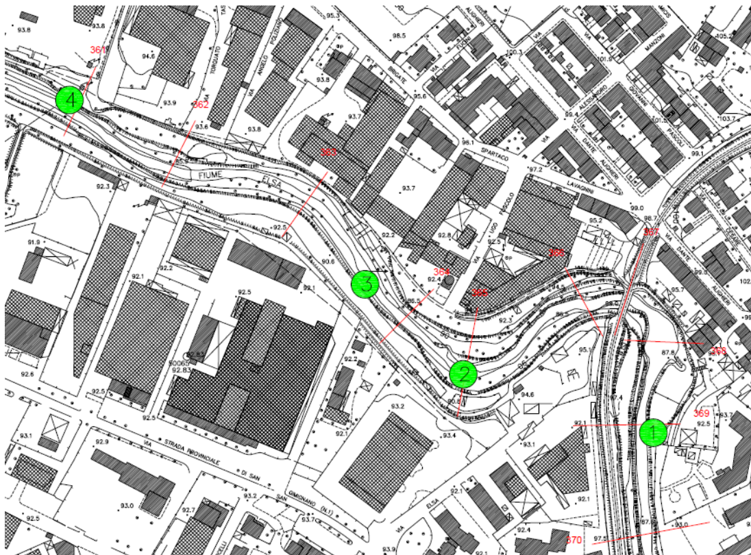
Fig. 49 – Scarichi rilevati lungo il tratto urbano del Fiume Elsa
