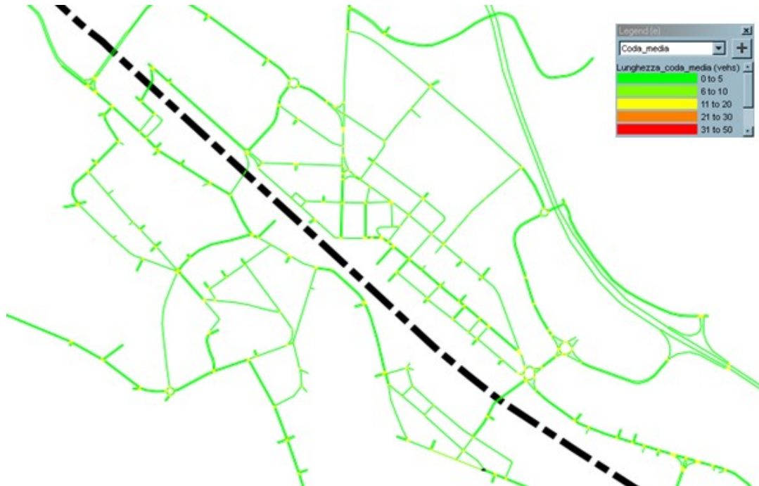
Figura 15: Lunghezza della coda media (numero di veicoli) per l'ora di punta mattutina – scenario di progetto
