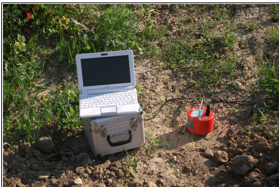
Figura 8 - Sismometro tricomponente Gemini 2 prodotto dalla ditta Pasi di Torino utilizzato per l'acquisizione delle vibrazioni ambientali per la prova H/V. Si nota il sismometro (colore arancione) e il computer portatile. Il sismometro è accoppiato con il terreno a mezzo di piedini appuntiti infissi a terra.
