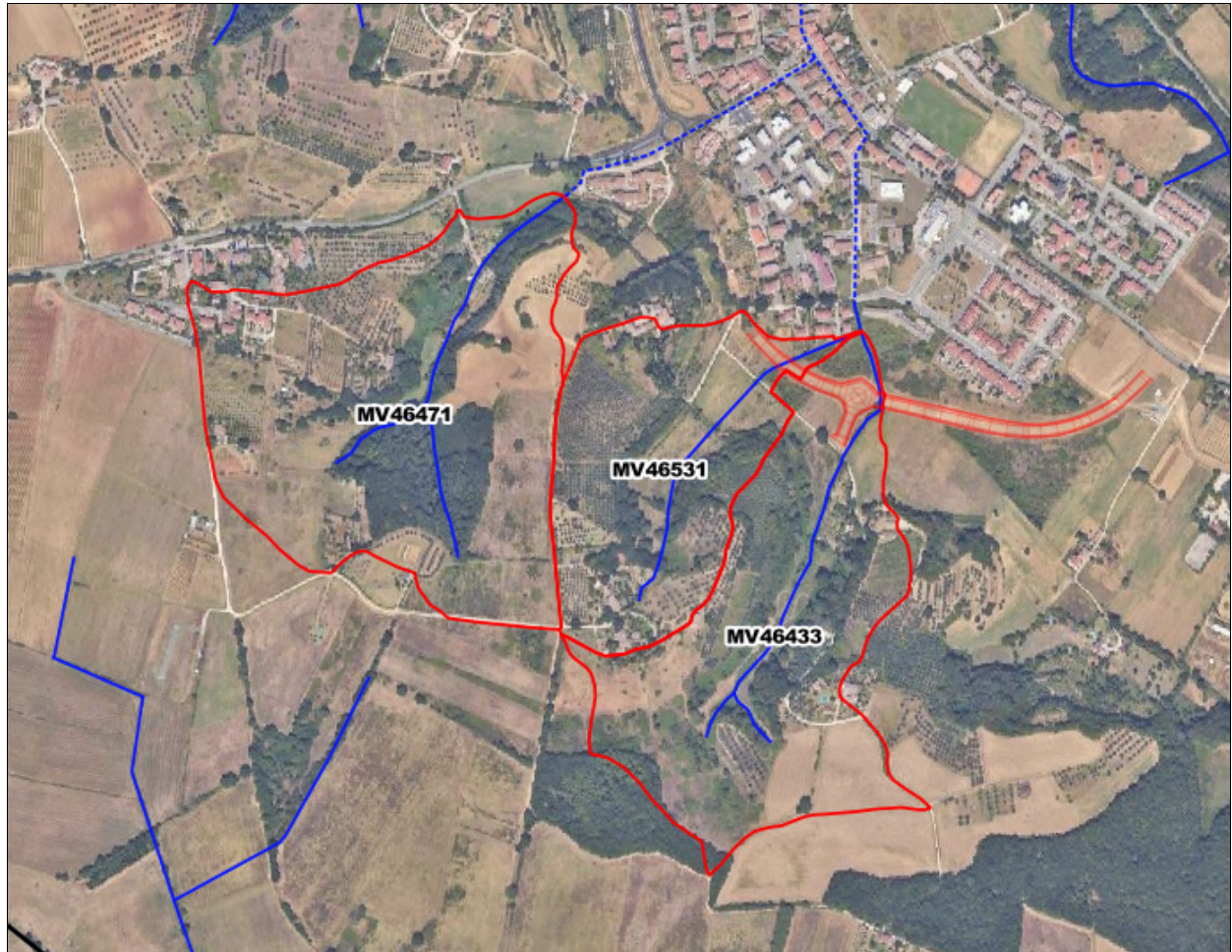
Fig. 7 – Bacini dei corsi d'acqua in Loc. Staggia, chiusi a monte dei tratti tombati
