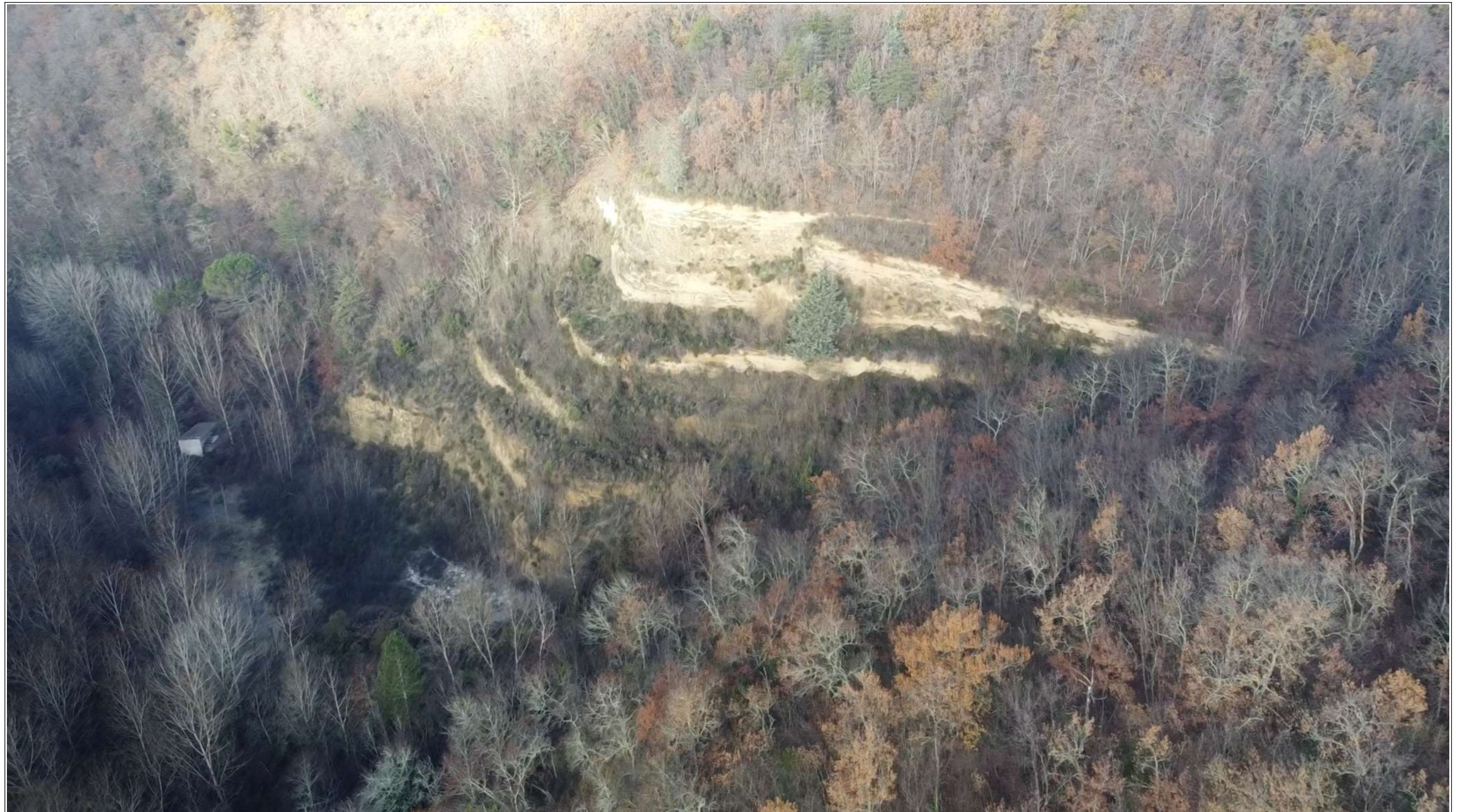
Figura 8 - Area del sito estrattivo dismesso RT0001543 sito in località Lisoia su immagine scattata con drone DJI Mini 2. Vista da sud est del fronte gradonato e del sottostante piazzale in cui si può osservare anche la presenza di un manufatto.
