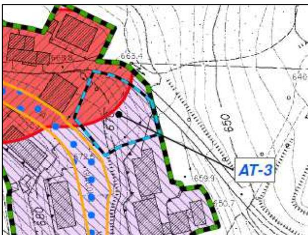
**Pericolosità Sismica:** L'area rientra in parte in S.3 --> da P.3a (Aree interessate da instabilità di versante quiescente) ed in parte in S.4 --> da P.4 (Aree interessate da instabilità di versante attive).
