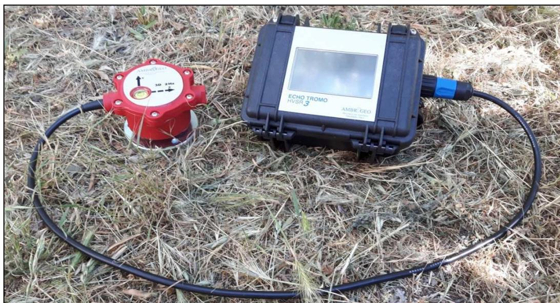
Figura 27 - EchoTromo HVSr 3” AMBROGEO, con geofono da 2 Hz
