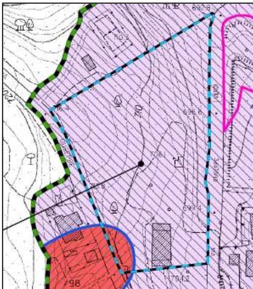
***Pericolosità Sismica:*** L'area rientra in parte in S.3 --> da P.3a (Aree interessate da instabilità di versante quiescente) ed in parte in S.4 --> da P.4 (Aree interessate da instabilità di versante attive).
