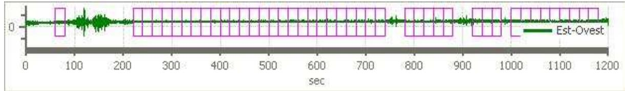
Figura 73 - Traccia e finestre selezionate in direzione Est - Ovest
