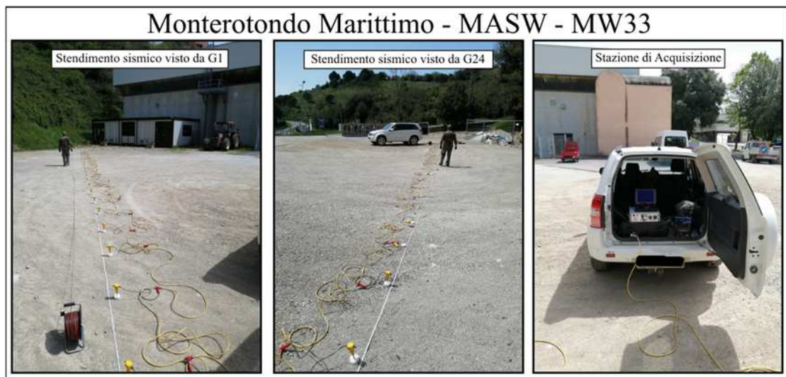
Figura 12 – Documentazione fotografica, relativa all'esecuzione dello stendimento MW33, eseguito a Monterotondo Mmo.
