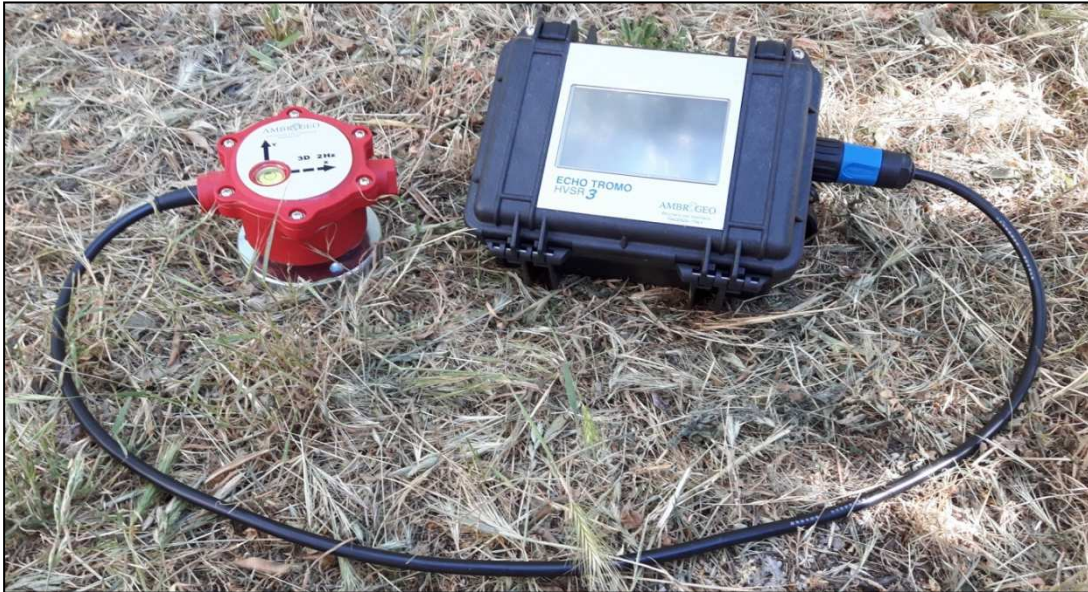
Figura 19 - EchoTromo HVSr 3" AMBROGEO, con geofono da 2 Hz
