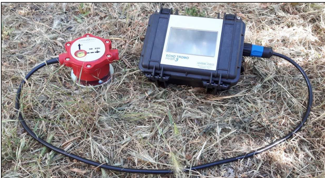
Figura 41 - EchoTromo HVSr 3 ” AMBROGEO , con geofono da 2 Hz
