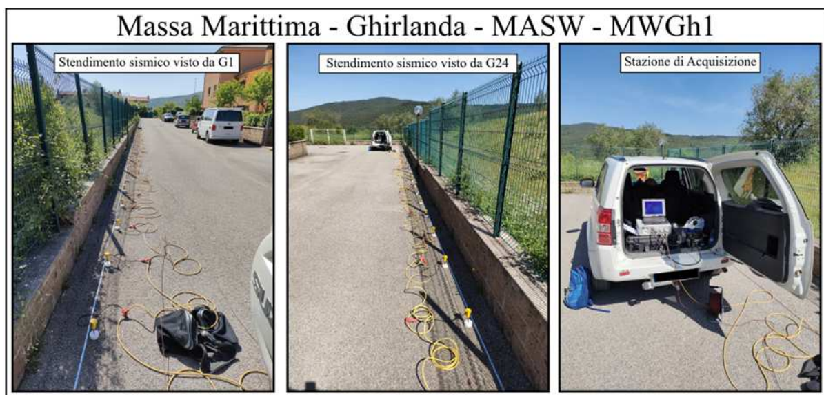
Figura 17 – Documentazione fotografica relativa all’esecuzione dello stendimento MWGh1
