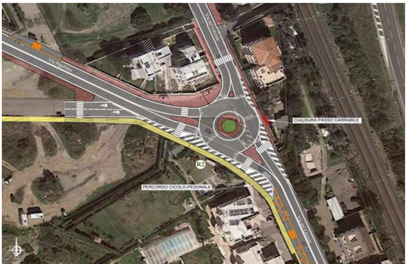
Proposta PUMS: nuova configurazione della rotatoria esistente tra la SS1 Aurelia e via di Levante
