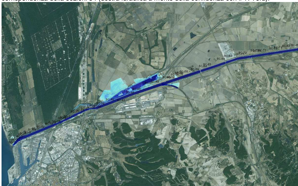
Figura 146 Allagamenti T_r=30 anni a t=28 h
