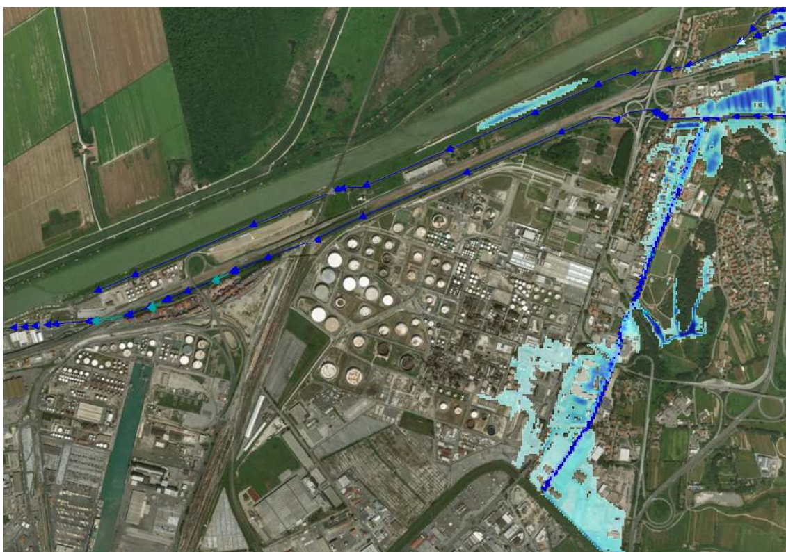
Figura 156 Dettaglio esondazioni dovuto al fosso delle acque chiare e Fosso Torretta nel comune di Livorno (Tr200 anni)
