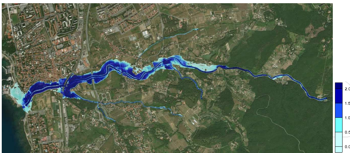
Figura 102 Tiranti idrici per il rio Ardenza per l'evento ricostruito (equivalente a Tr500 anni)
