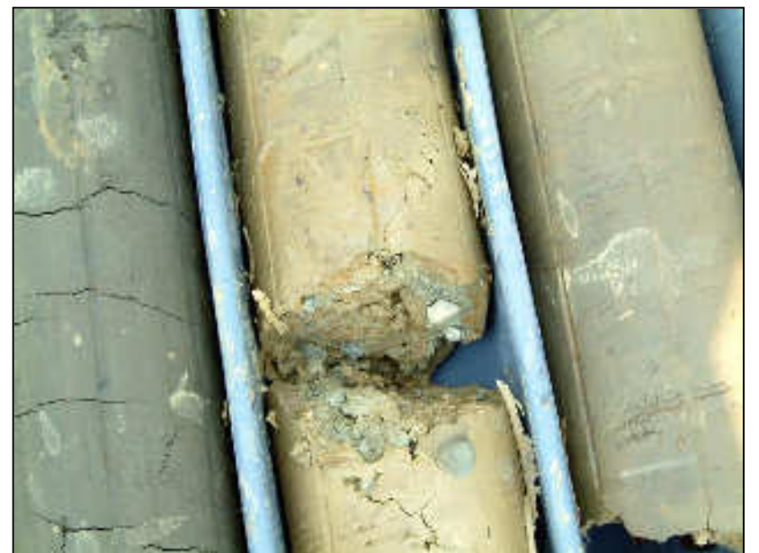
PARTICOLARE INTERVALLO ARGILLOSO CENTRALE CON SPORADICO GHIAIETTO
