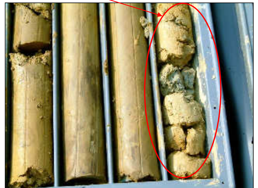
PARTICOLARE INTERVALLO ARGILLOSO 1.5-4.5 E SABBIE SOTTOSTANTI 4.5-5.0
