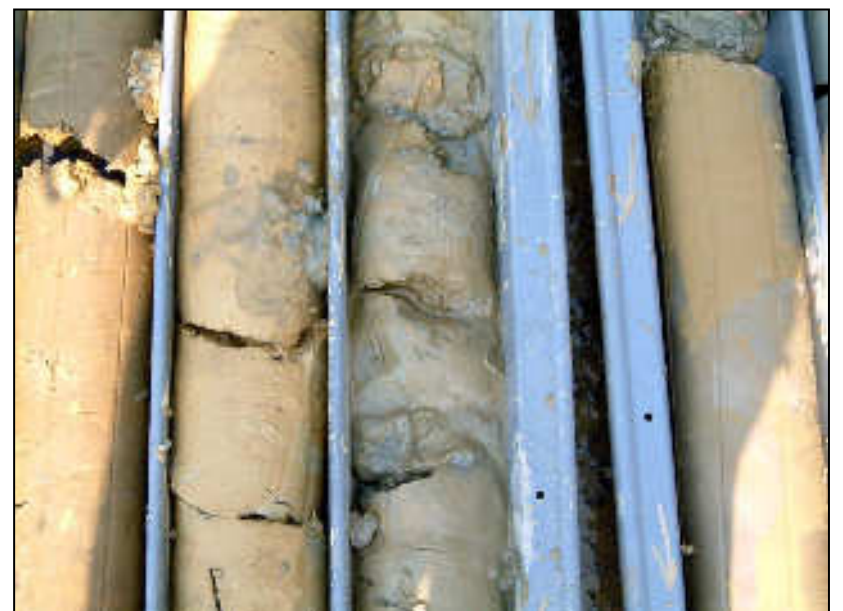
PARTICOLARE INTERVALLO SABBIOSO SOVRASTANTE LE ARGILLE BASALI
