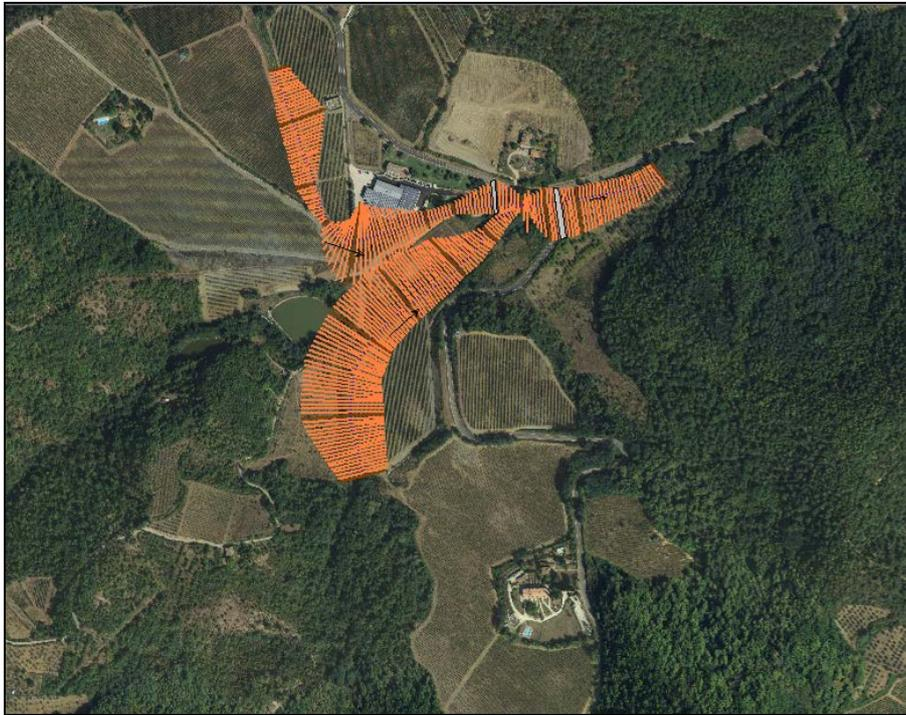
**Figura 13** – Planimetria del modello Dudda in Hec-Ras
