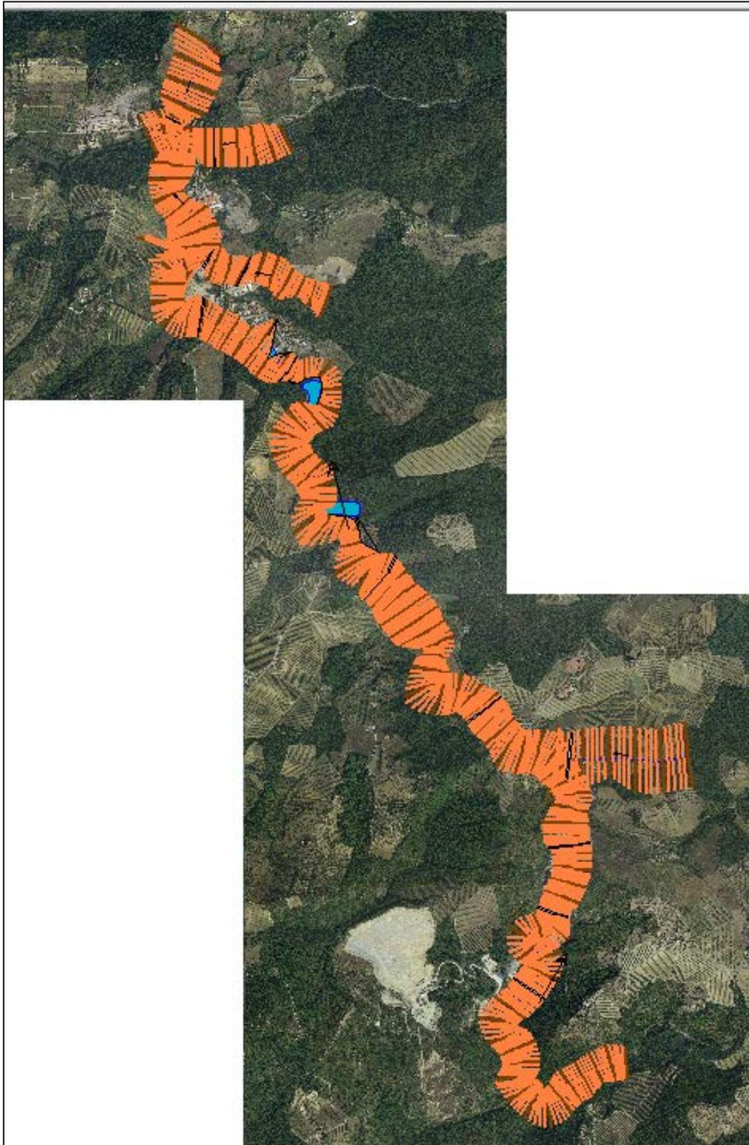
**Figura 12** – Planimetria del modello Greve in Hec-Ras, porzione di valle
