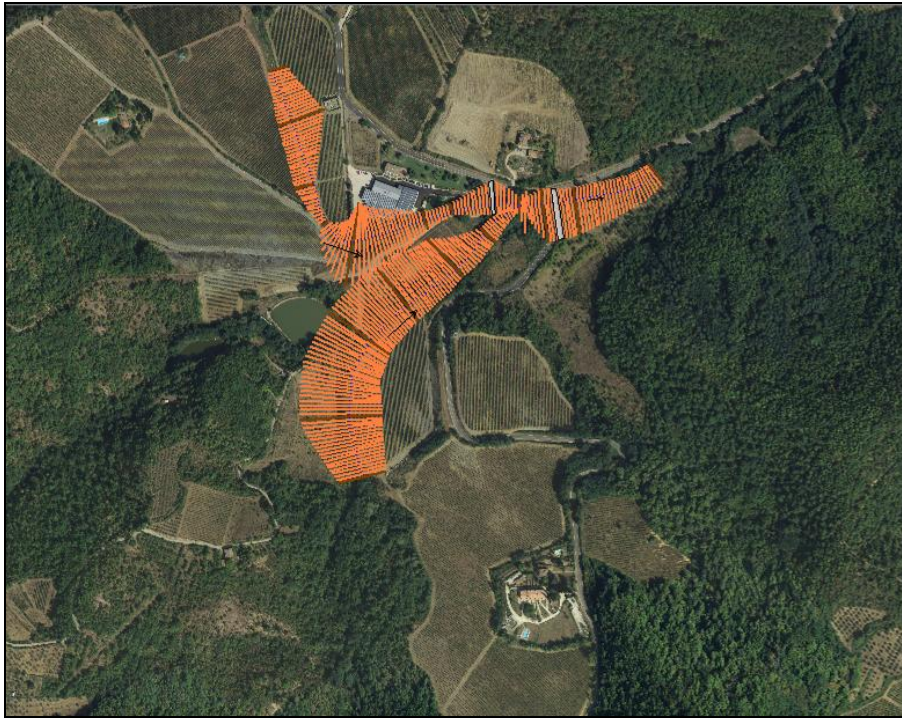
Figura 13 – Planimetria del modello Dudda in Hec-Ras
