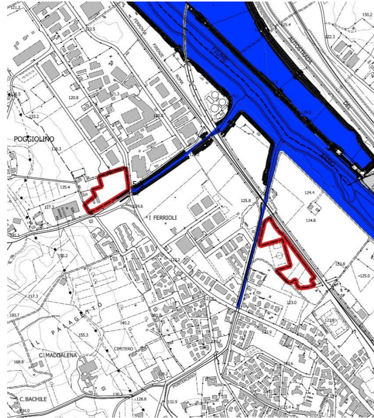
Estratto tavola D0.13 PLANIMETRIA DELLE AREE INONDABILI DAL F. ARNO E TRATTI DI RIGURGITO - STATO DI PROGETTO - CASSE DI ESPENSIONE DI FIGLINE - LOTTO PRULLI - PROGETTO ESECUTIVO
