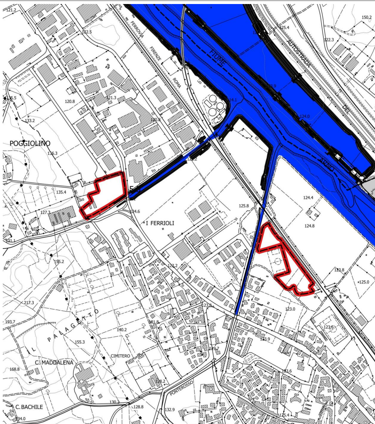
Figura 2-5: Estratto tavola D0.13 PLANIMETRIA DELLE AREE INONDABILI DAL F. ARNO E TRATTI DI RIGURGITO - STATO DI PROGETTO - CASSE DI ESPANSIONE DI FIGLINE - LOTTO PRULLI - PROGETTO ESECUTIVO (comprensiva delle opere previste sul T. Ponterosso nel Progetto della cassa di espansione di Restone)
