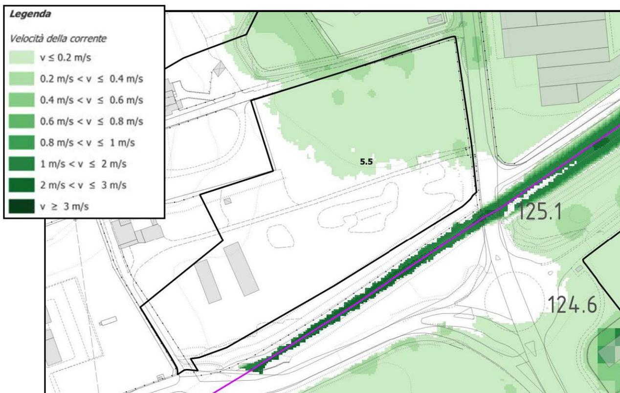
Figura 14.5 – Velocità della corrente per alluvione poco frequente (Tr 200 anni)
