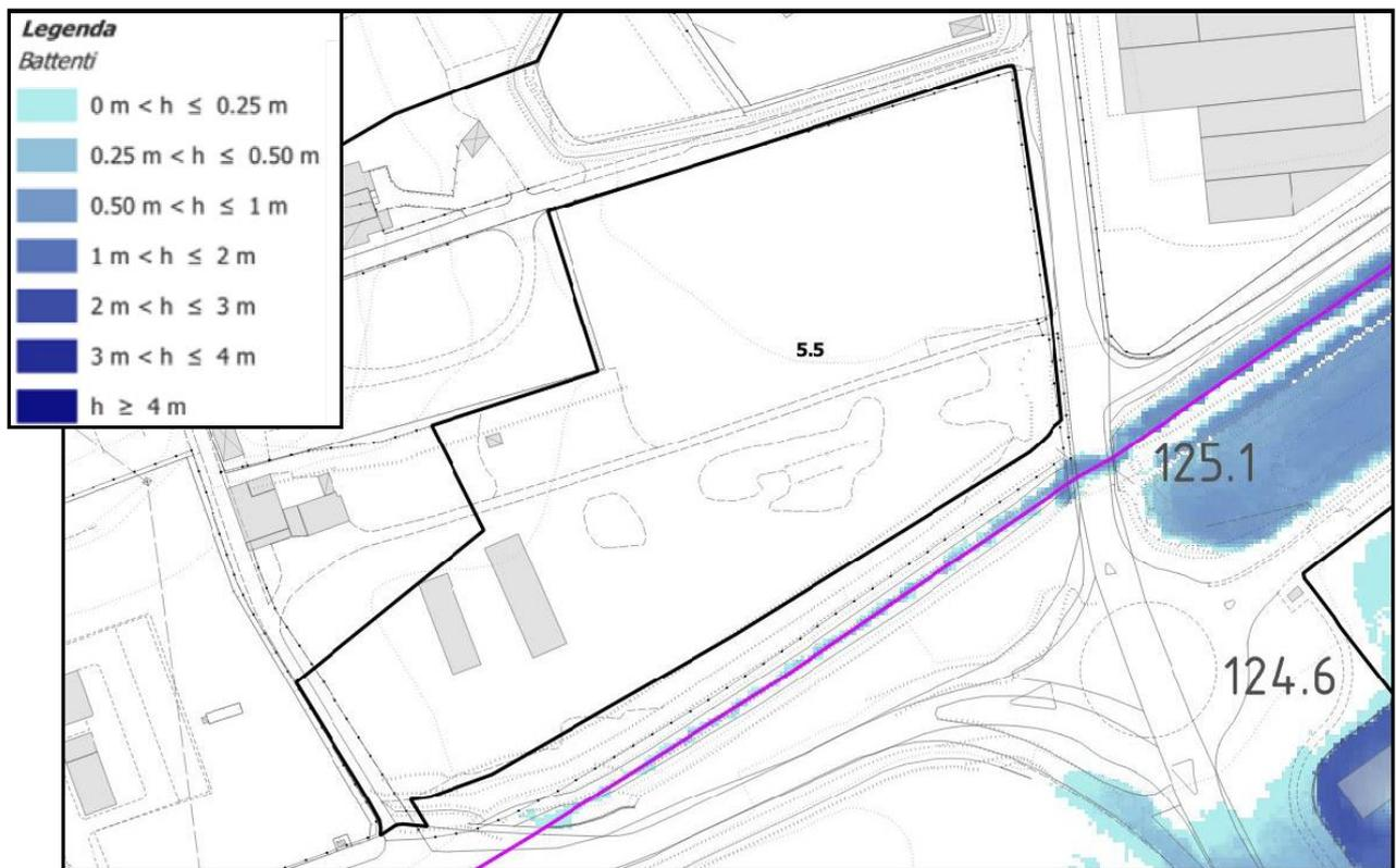
Figura 14.3 – Battenti idraulici per alluvione frequente (Tr 30 anni)
