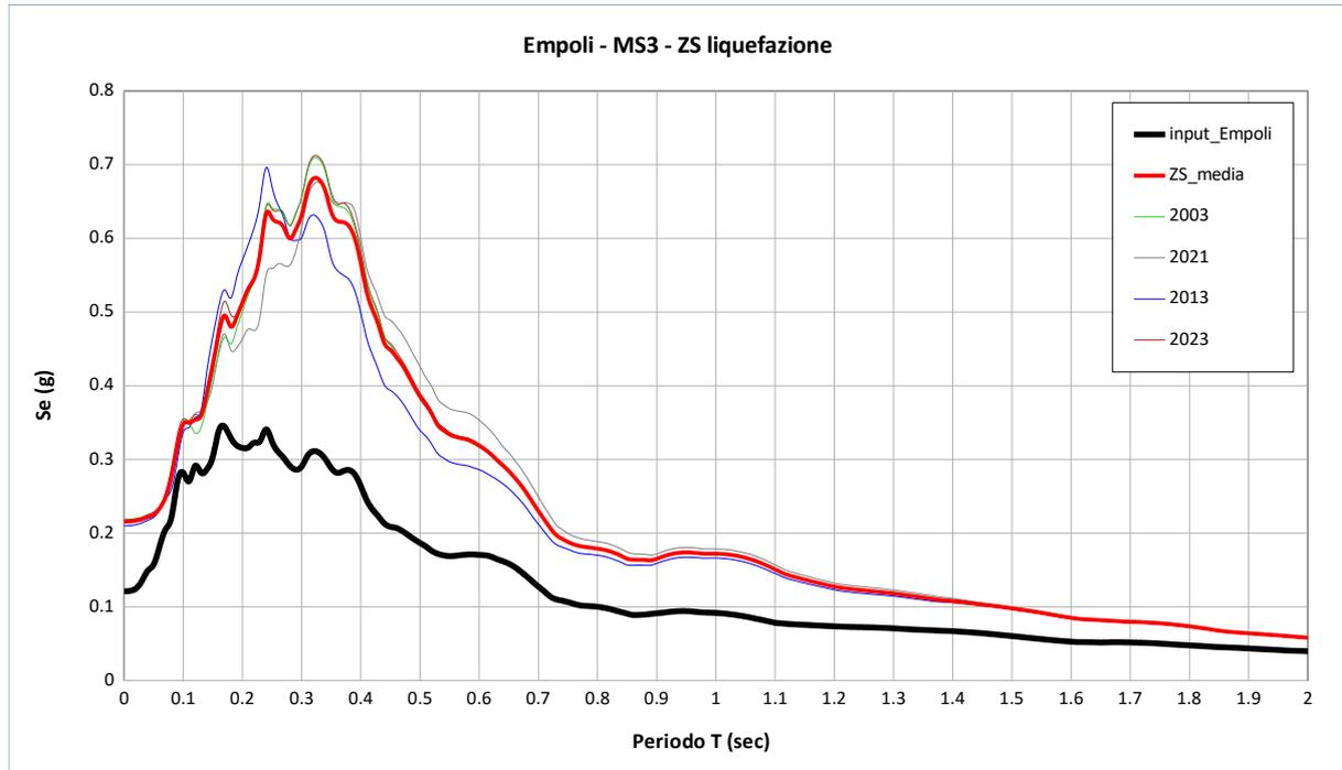
**Fig.7** – Spettri medi in pseudoaccelerazione per i quattro siti indagati. La curva rossa illustra lo spettro medio dei 4 estrapolati, utilizzato per la definizione dell'azione sismica nel presente studio. La curva nera, invece, rappresenta lo spettro di input
