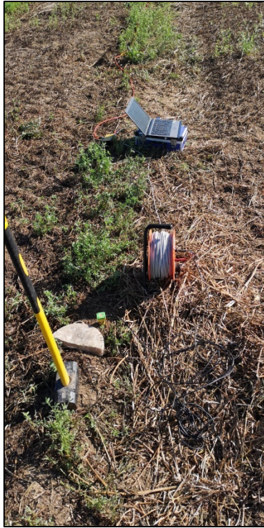
Foto – Indagine sismica a rifrazione SR_3
