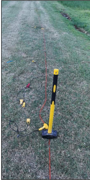
Foto – Indagine sismica a rifrazione SR_2
