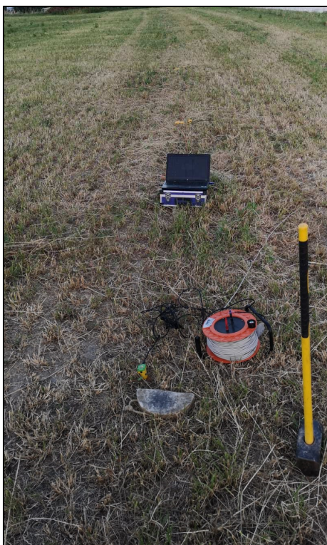
Foto – Indagine sismica a rifrazione SR_4
