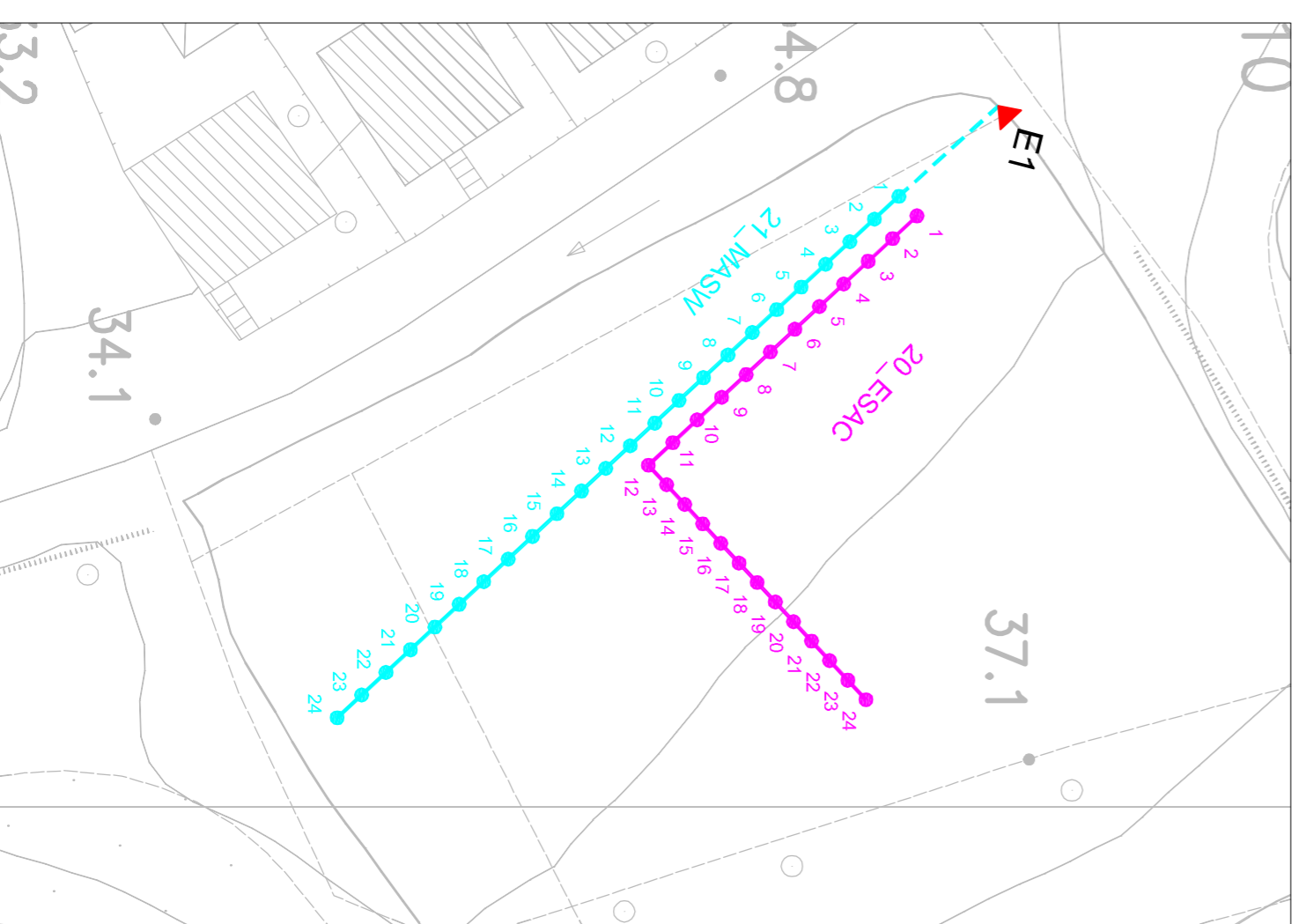
20_ARRAY SISMICO ESAC E 21_MASW - SCALA 1:500
