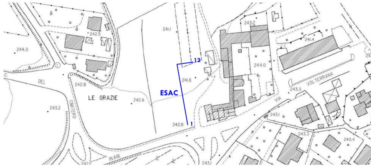
1 ESAC 12 Stendimento di sismica passiva ESAC
