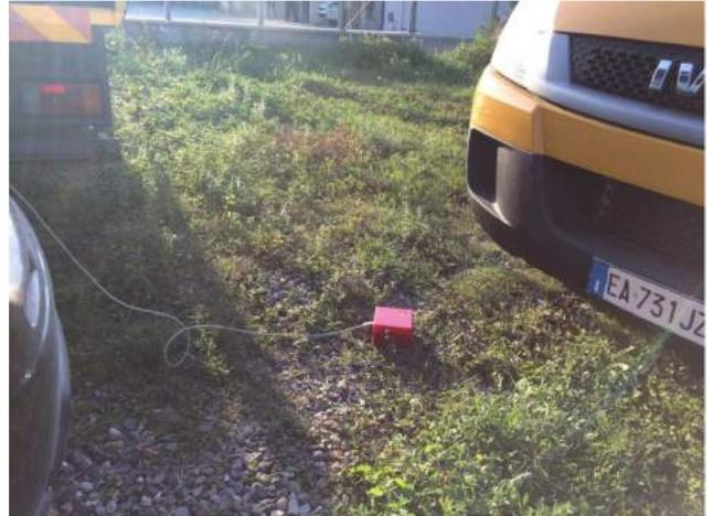
**Qualità della misura:****MISURA TIPO A2****HVSR15**Peak frequency (Hz): 0.9 ( $\pm 4.9$ )Peak HVSR value: 1.4 ( $\pm 0.3$ )
