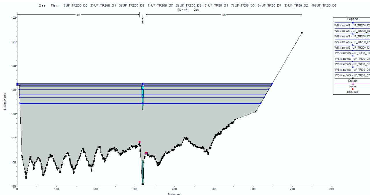
**Figura 7.33** – Particolare modello HEC-RAS “Elsa”, cassa di laminazione sul Torrente Scarna
