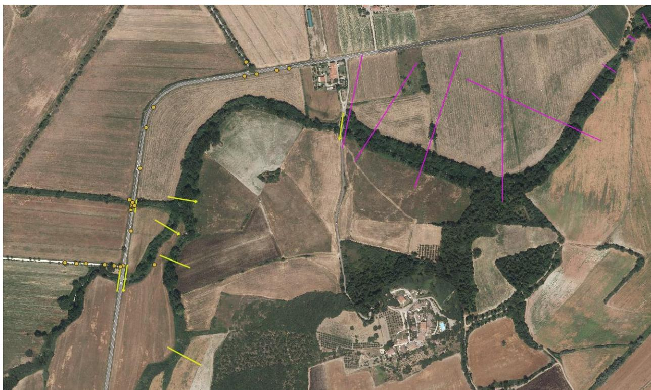
**Figura 4.2** – Ortofoto con sezioni e punti rilevati (giallo) e sezioni da studi precedenti (magenta) per modellazione area confluenza.
