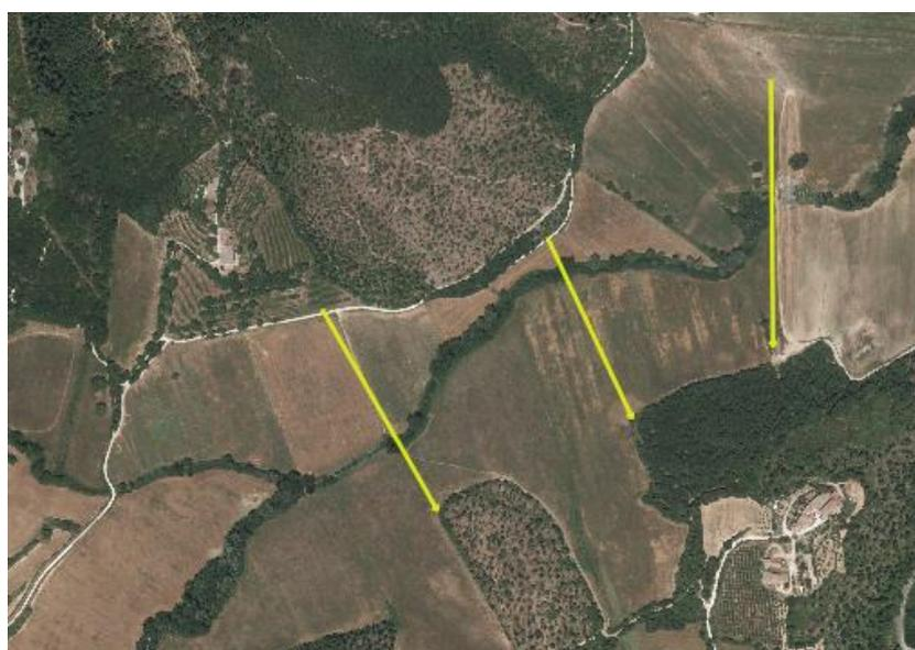
**Figura 4.1** – Ortofoto con sezioni rilevate a monte della traversa per modellazione cassa.
