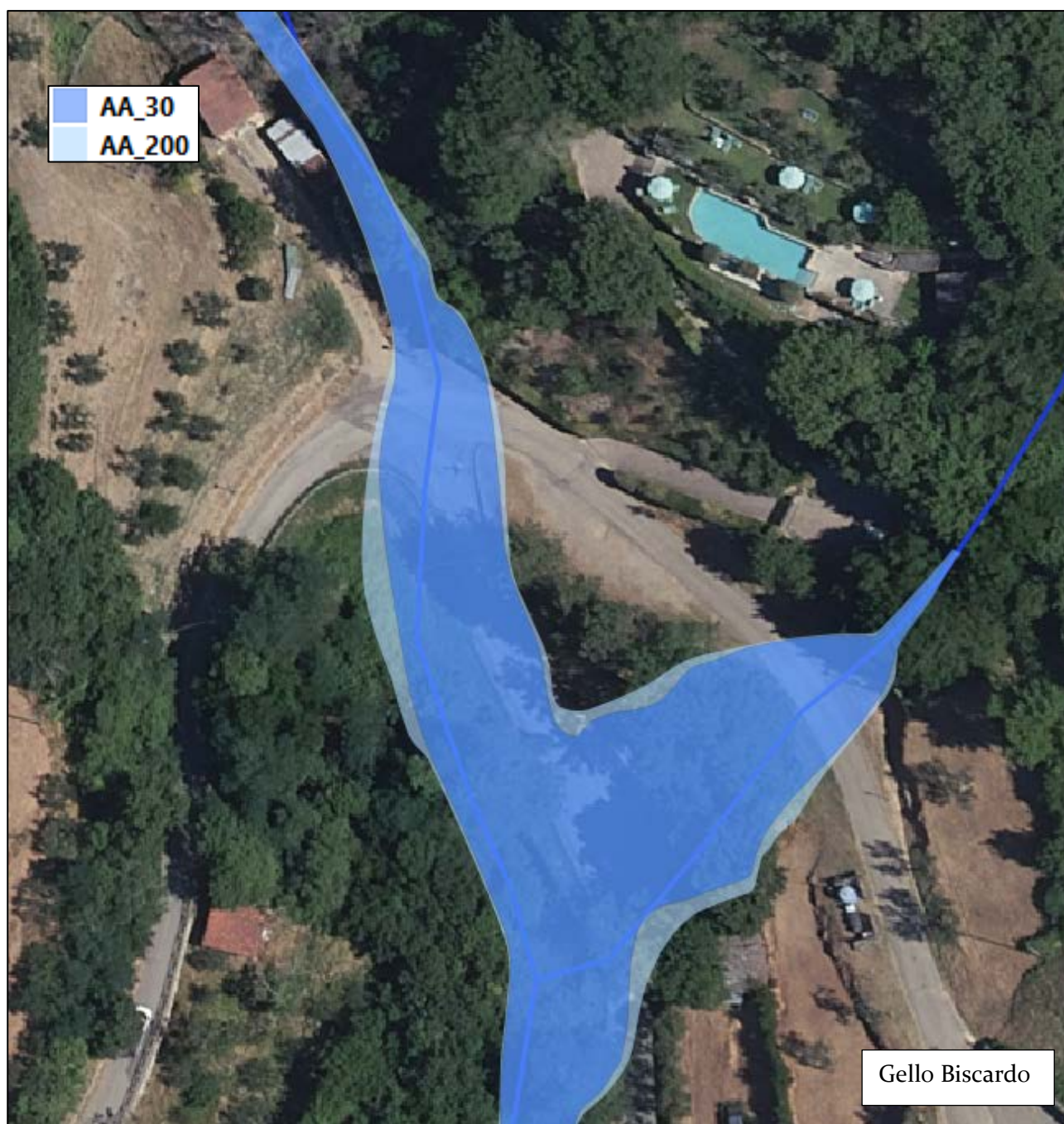
Figura 6-5 Aree allagate provocate dai volumi esondati dal Fosso del Castagno e dal suo affluente sinistro lungo la viabilità d'ingresso dell'abitato di Gello Biscardo
