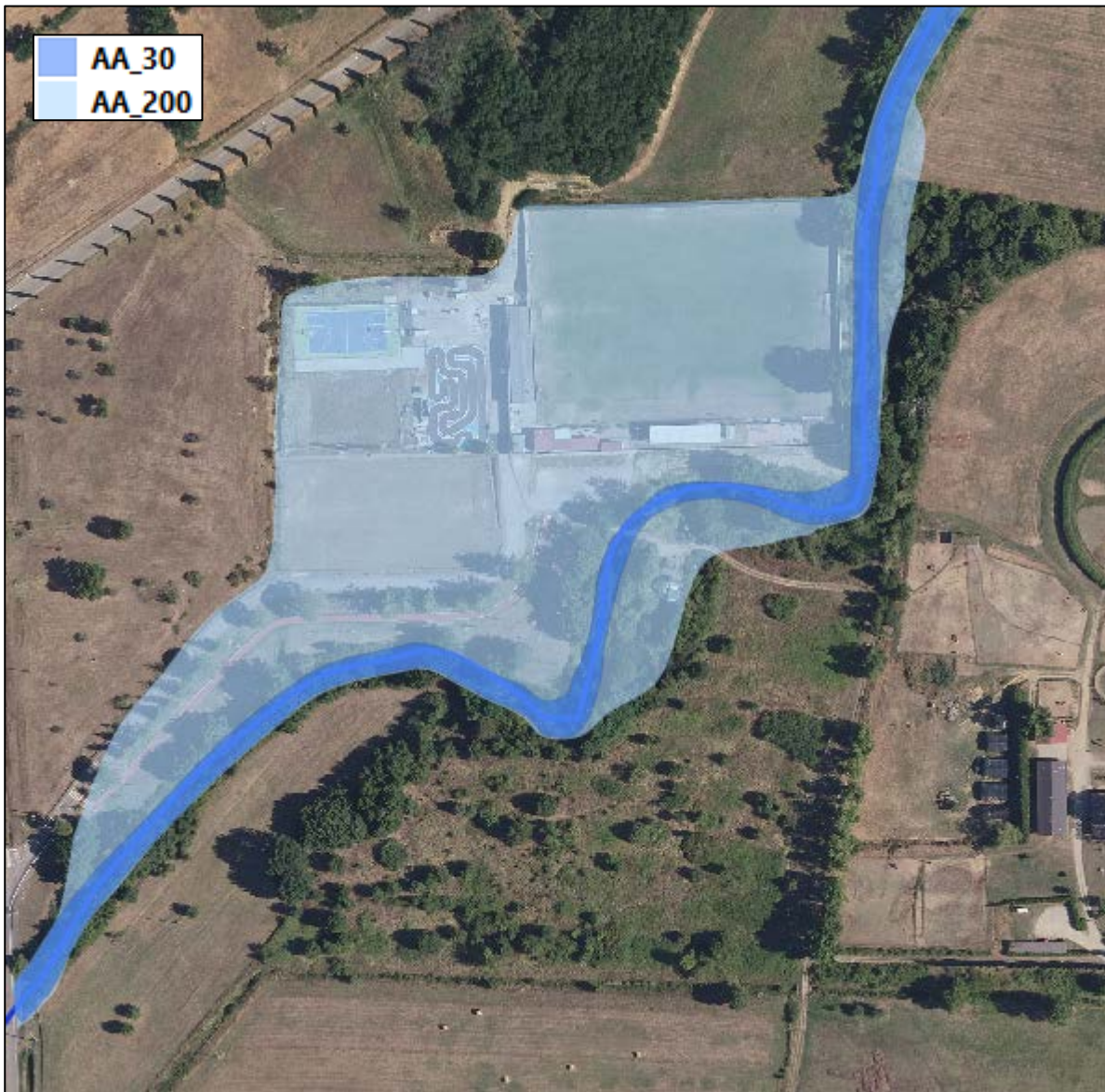
Figura 6-15 Aree allagate per Tr200 e Tr30 anni nella zona degli impianti sportivi di Castiglione Fibocchi
