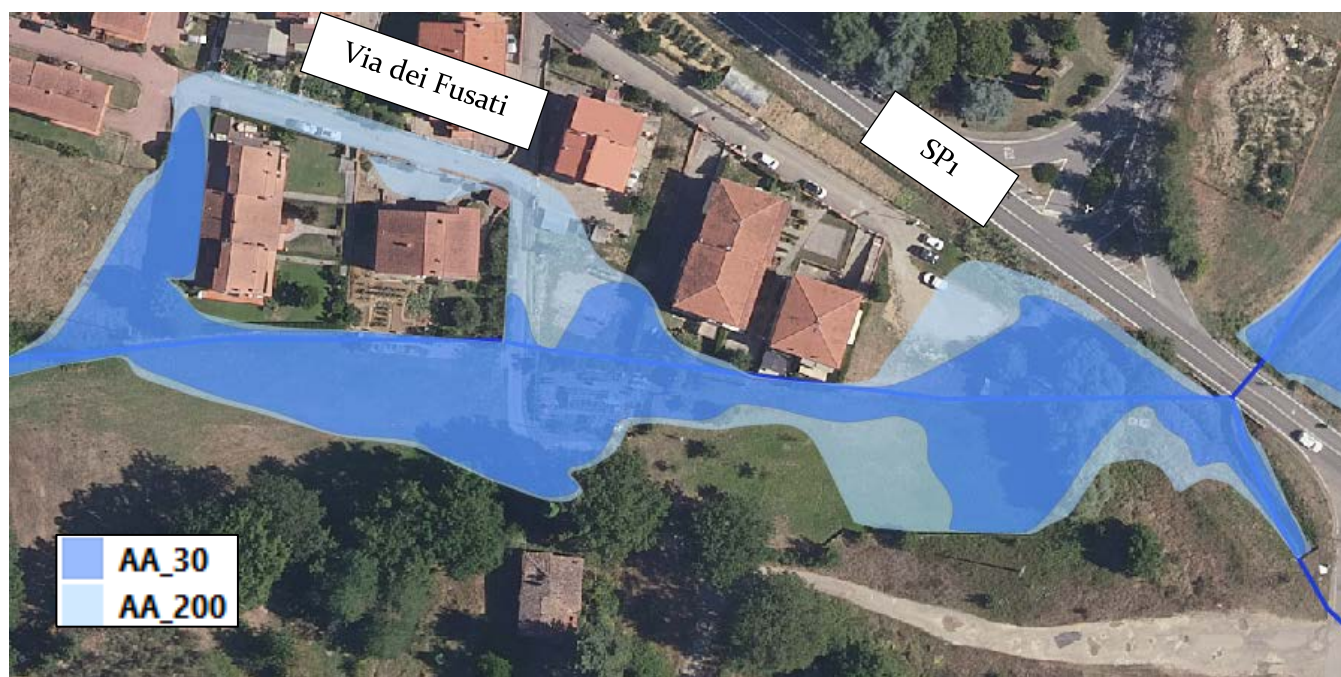
Figura 6-28 Aree allagate per Tr200 anni nell'area residenziale lungo il Fosso di San Piero
