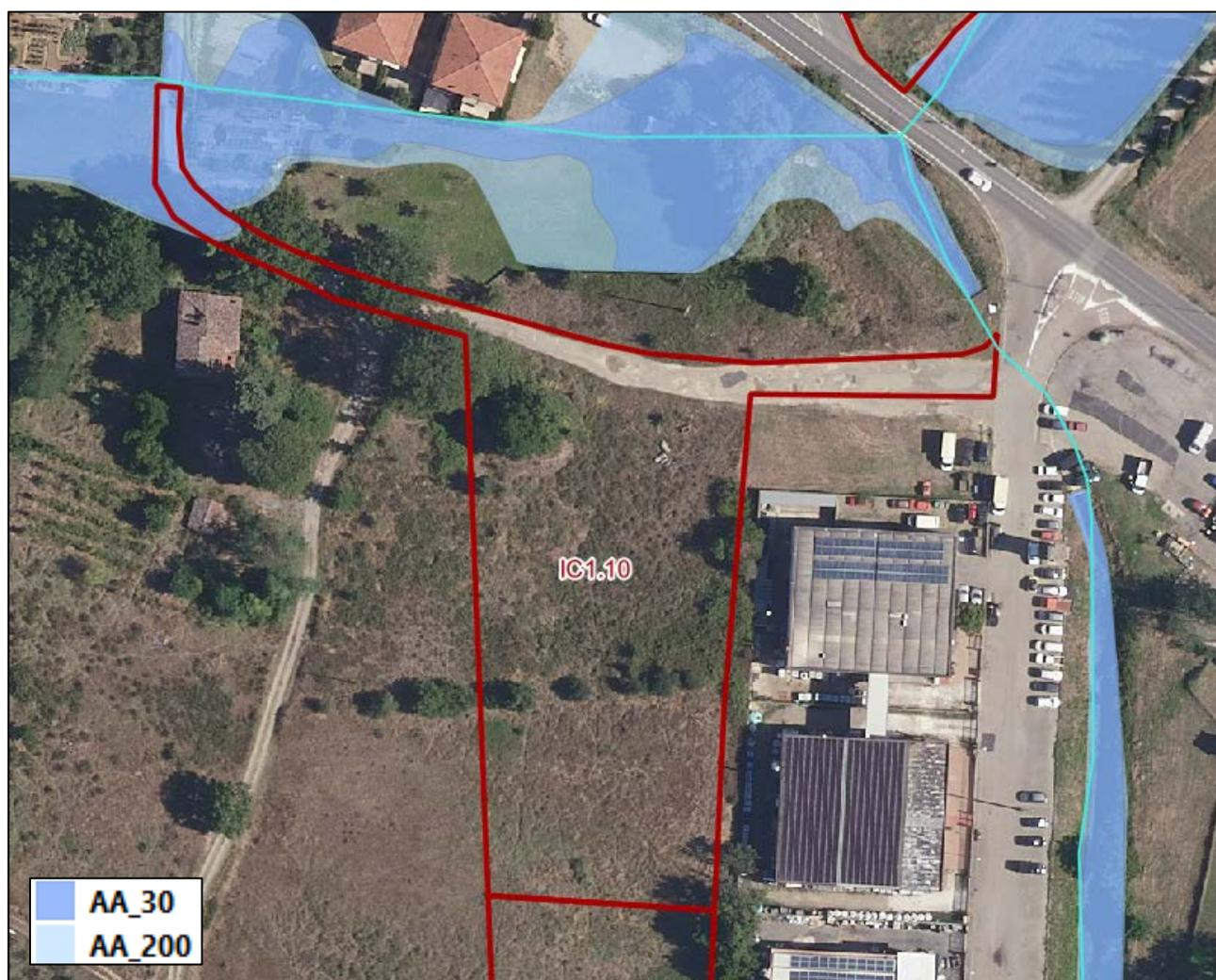
Figura 2-3 – Inquadramento dell'intervento, in azzurro Pericolosità d'alluvioni poco frequente, in blu Pericolosità d'alluvione frequente
