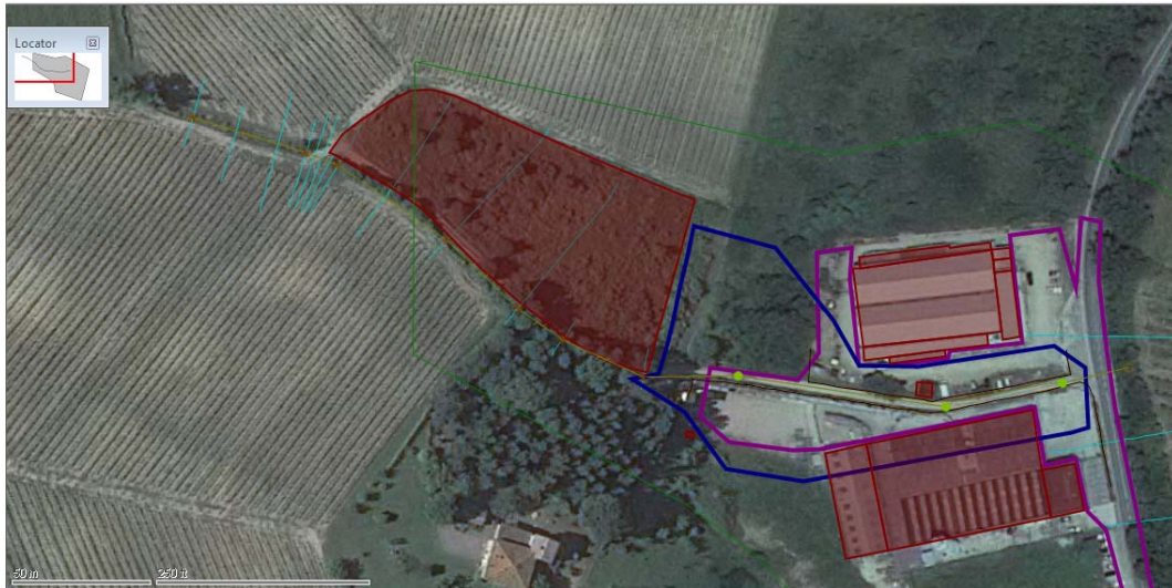
Figura 1.5 Modello idraulico C.Cellani stato di progetto- estratto da ICM – Scenario BETA Tr200 Massimo allagamento.
