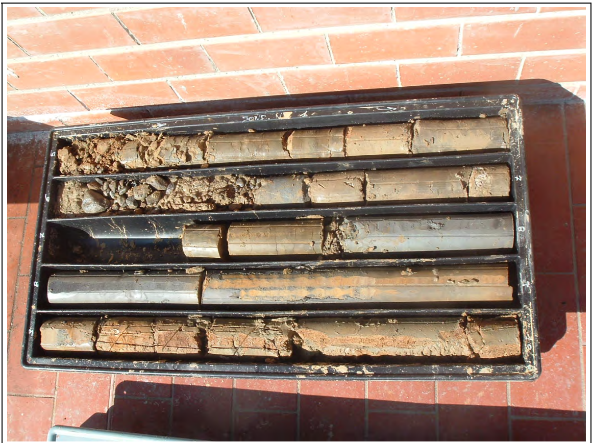
Sondaggio S1, profondità 5.0 – 10.0 m
