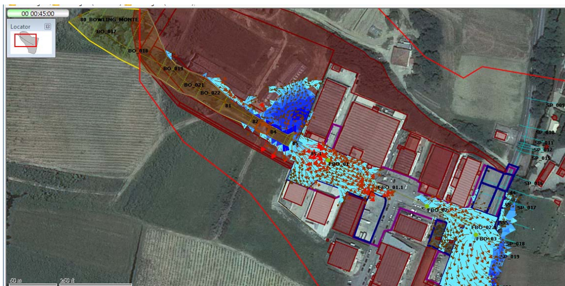
Figura 3.7 Modello idraulico Zona Ind. Botriolo - estratto da ICM – Scenario BETA Tr200 Istante simulazione 00:45h (inizio sfioro su viabilità lottizzazione).
