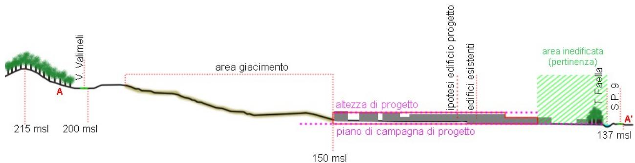
Sezione stato sovrapposto – scala 1:5.000
