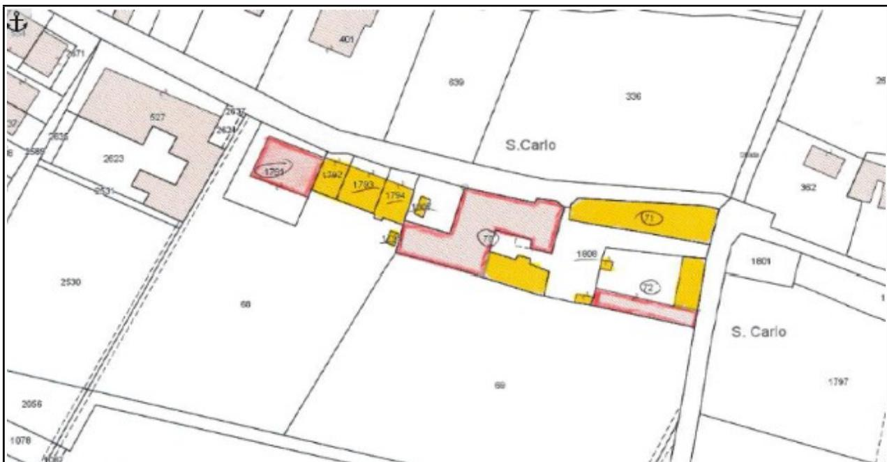
Fig. 2 - Planimetria catastale, in giallo gli edifici oggetto di demolizione
