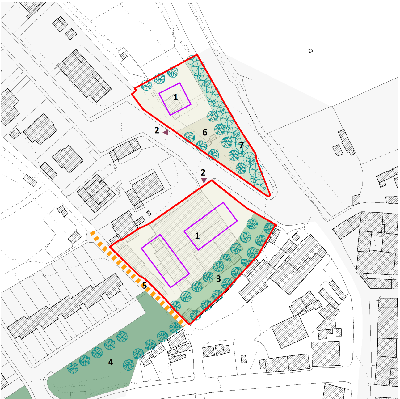
Schema di riferimento: 1 – aree destinate alla nuova edificazione con sedime indicativo dei nuovi volumi (altezza massima 2 piani)
