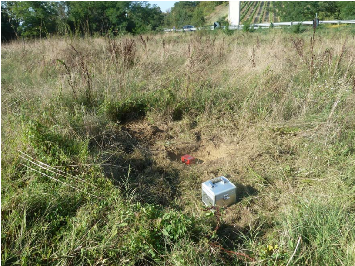
Sito 16 Indagine in sismica passiva HVSR_16 – Documentazione fotografica.
