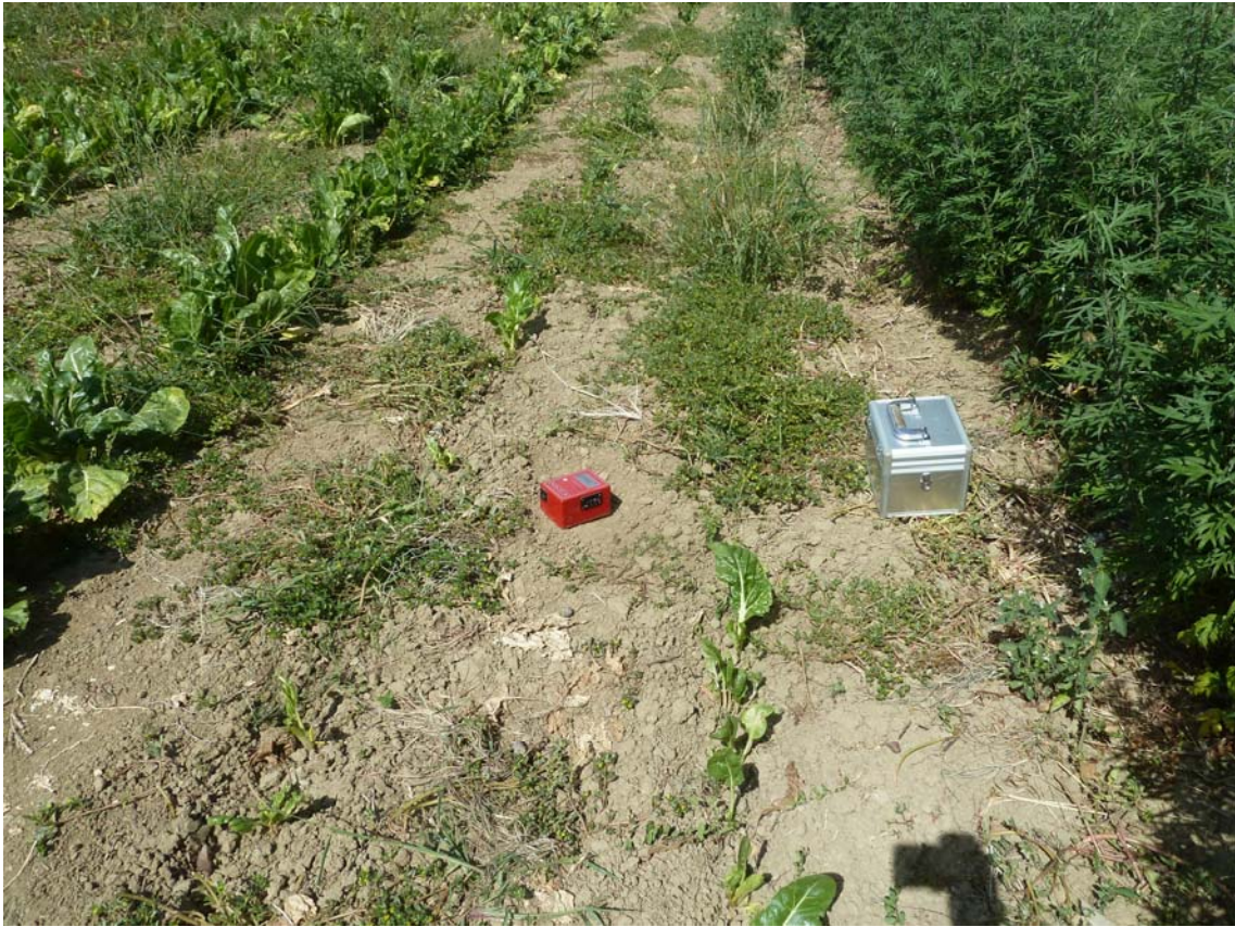
Sito 03. Indagine in sismica passiva HVSR_03 – Documentazione fotografica.
