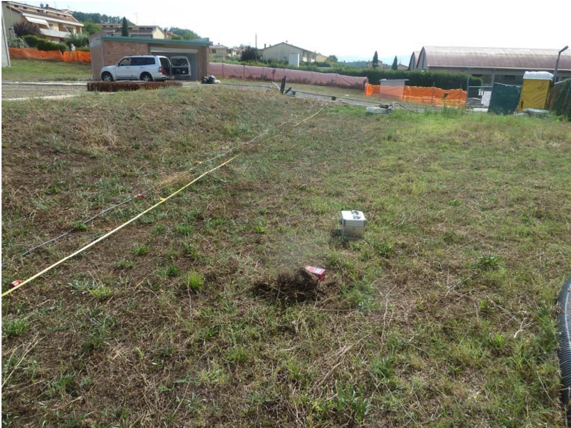
Sito 07 Indagine in sismica passiva HVSR_07 – Documentazione fotografica.
