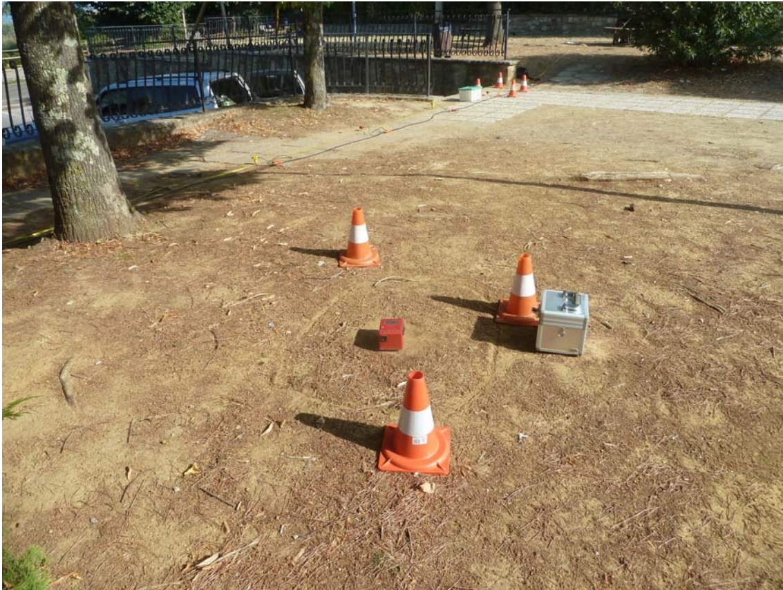
Sito 10 Indagine in sismica passiva HVSR_10 – Documentazione fotografica.
