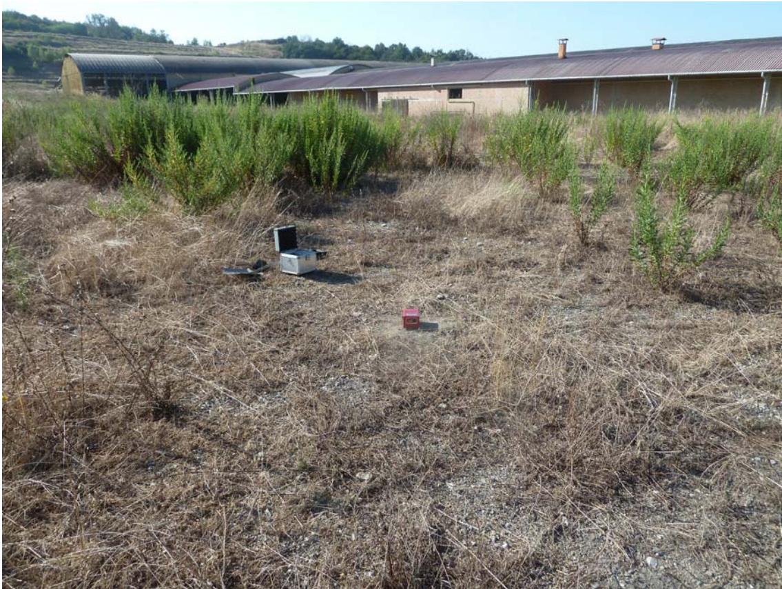
Sito 01. Indagine in sismica passiva HVSR_01 – Documentazione fotografica.
