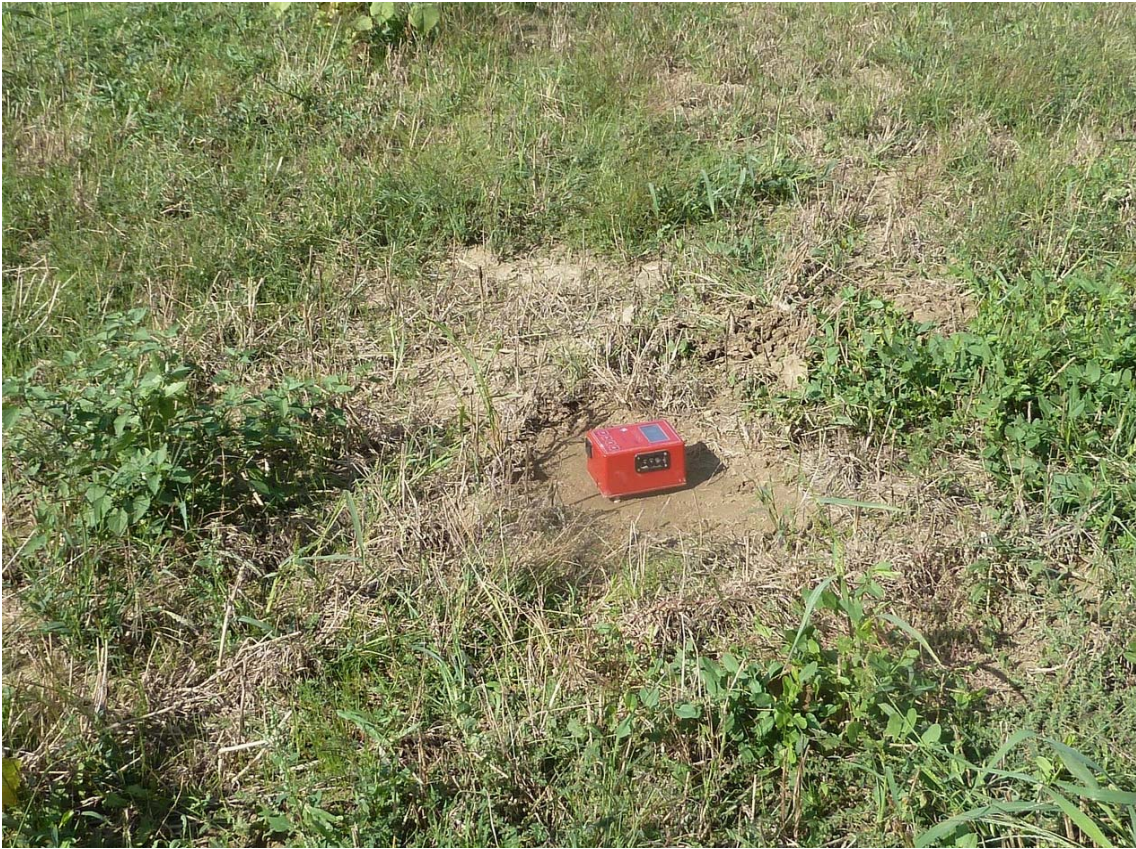
Sito 12 Indagine in sismica passiva HVSr_12 – Documentazione fotografica.
