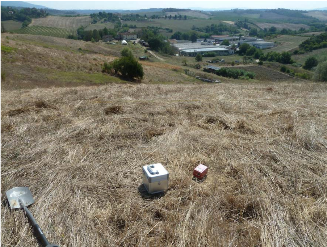
Sito 18 Indagine in sismica passiva HVSr_18 – Documentazione fotografica.
