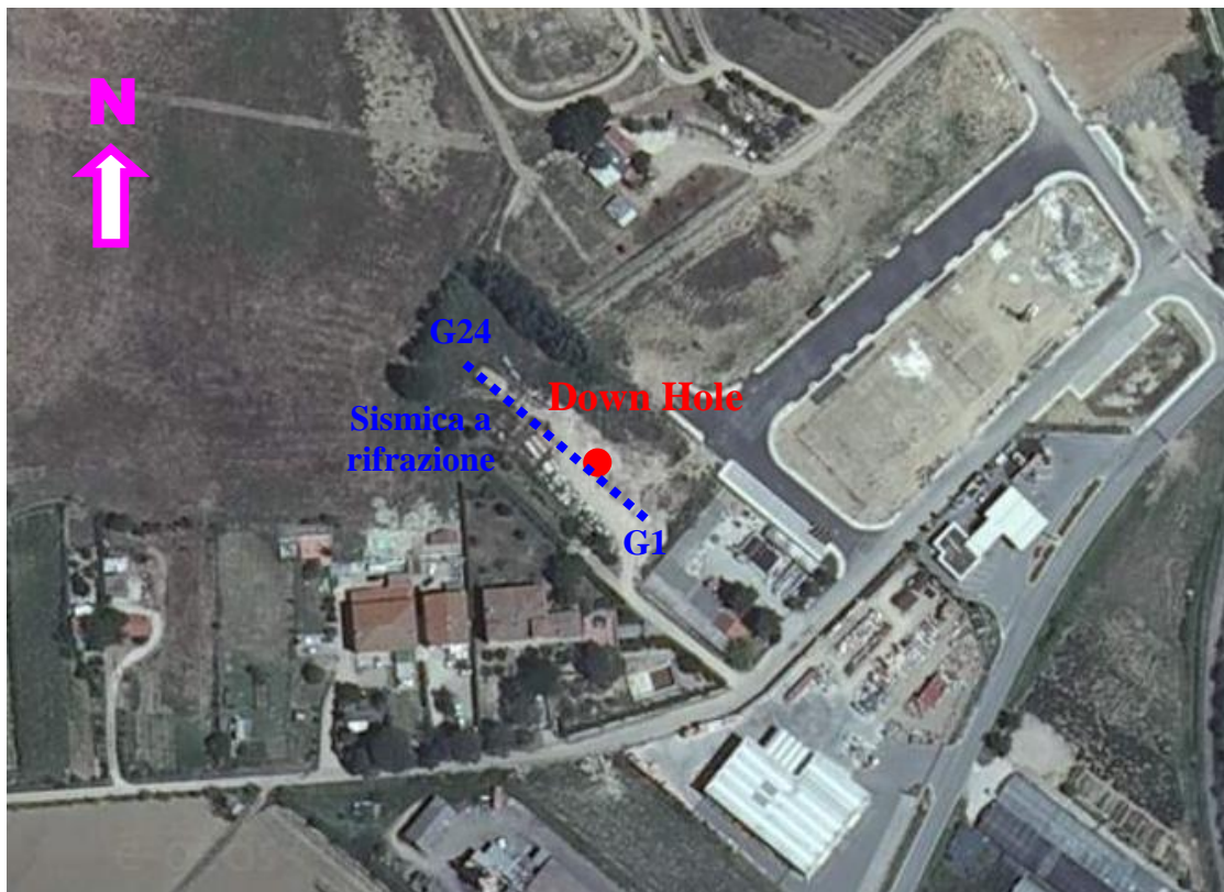
Ubicazione indagine down-hole (in rosso)
