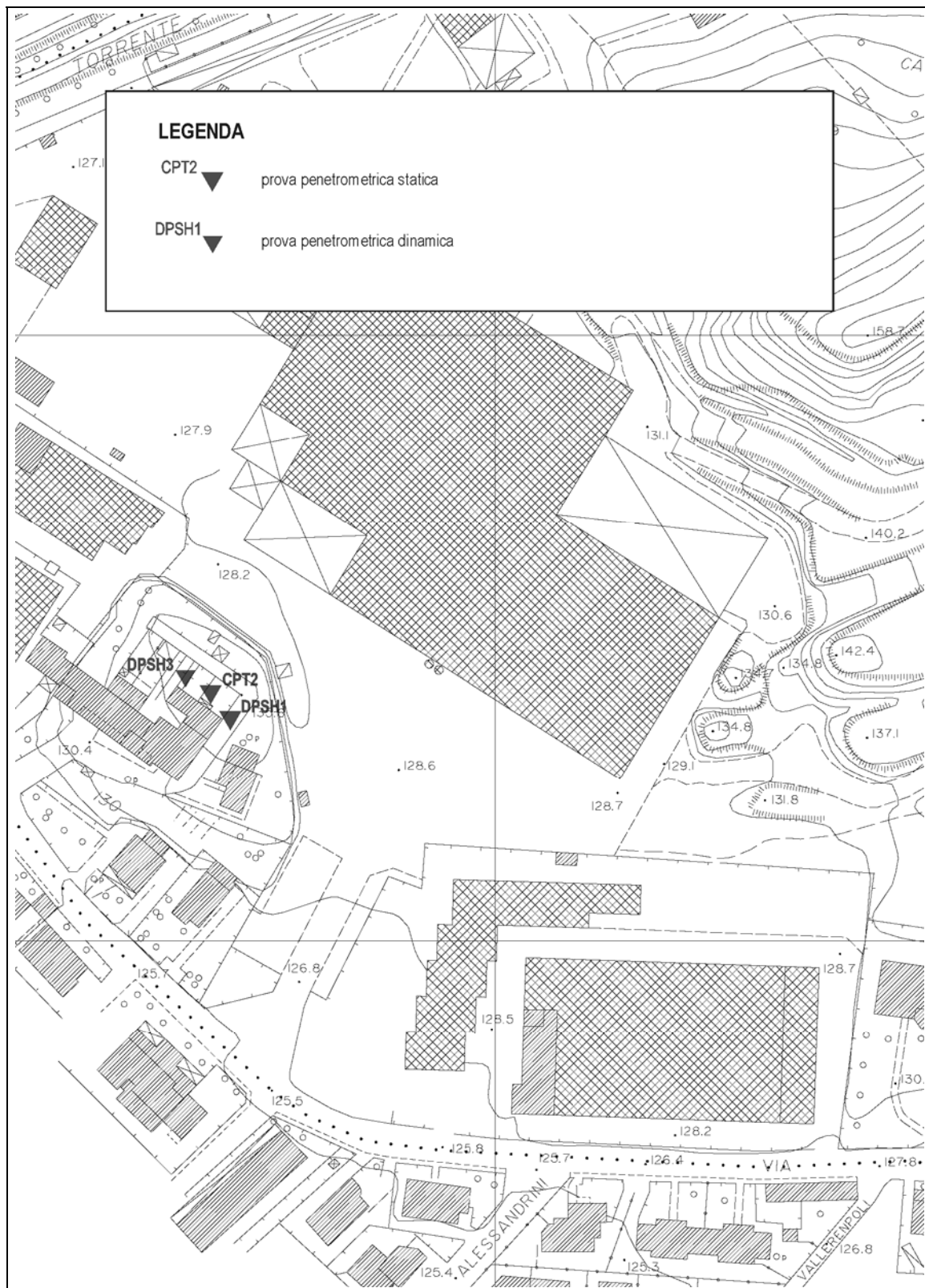
Ubicazione delle indagini geognostiche su estratto, in scala 1:2.000, della Carta Tecnica Regionale.
