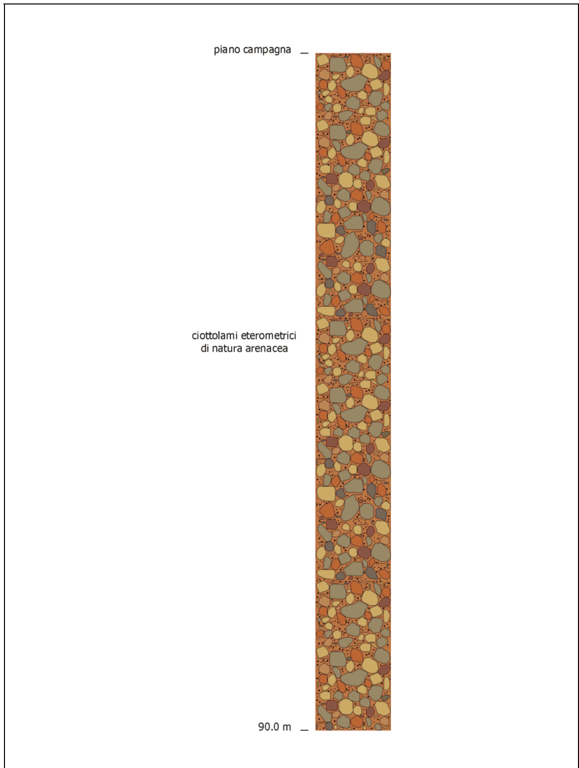
Stratigrafia della perforazione in scala 1:500.
