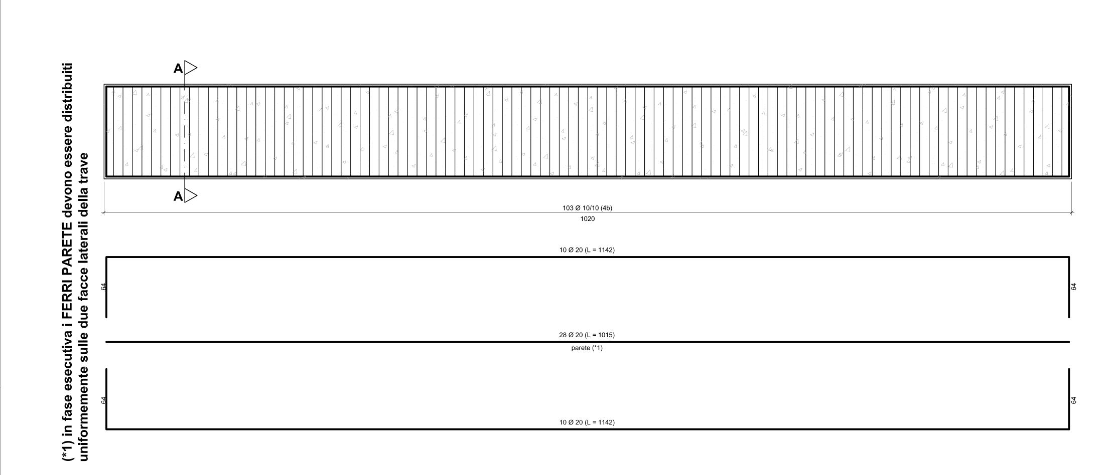
SEZIONE LONGITUDINALE ARMATURA DELLA SPALLA DEL PONTE scala 1:20
