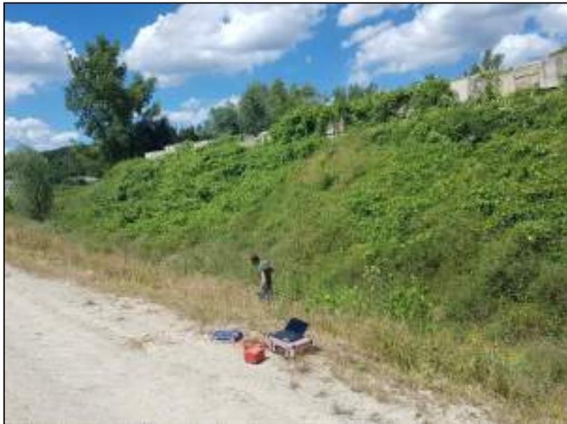
Fase di acquisizione misura di rumore sismico HVSR (sezione 1-1').
