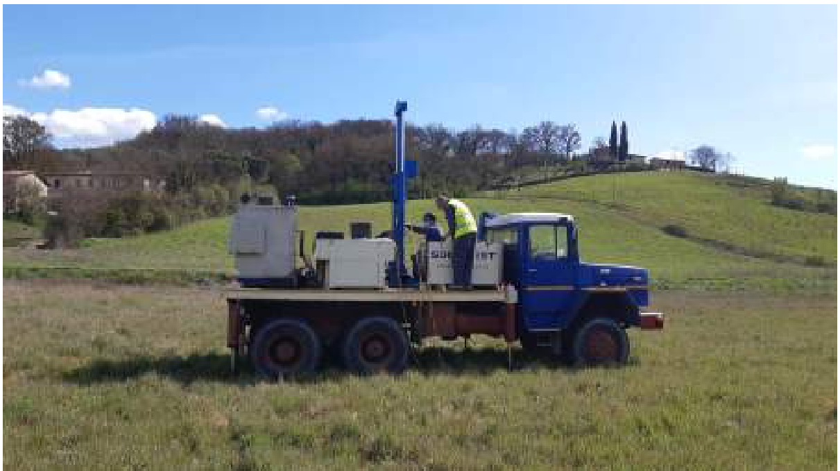
Prove penetrometriche punta elettrica (CPT) e dilatometriche (DMT)
