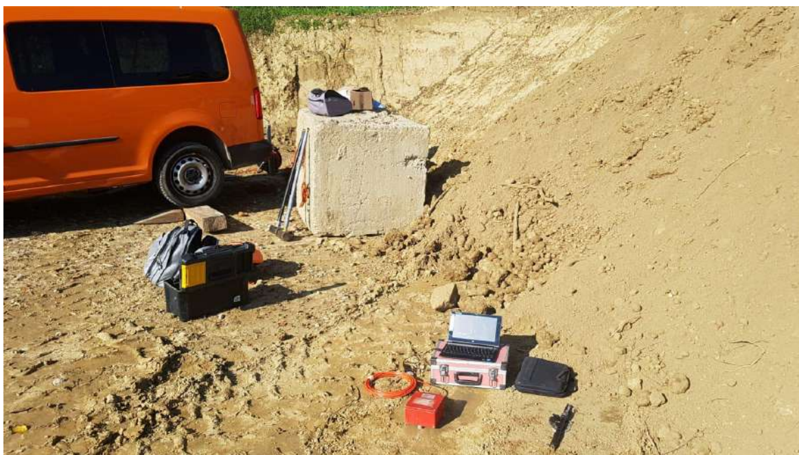
Fase di acquisizione misura di rumore sismico HVSR.
