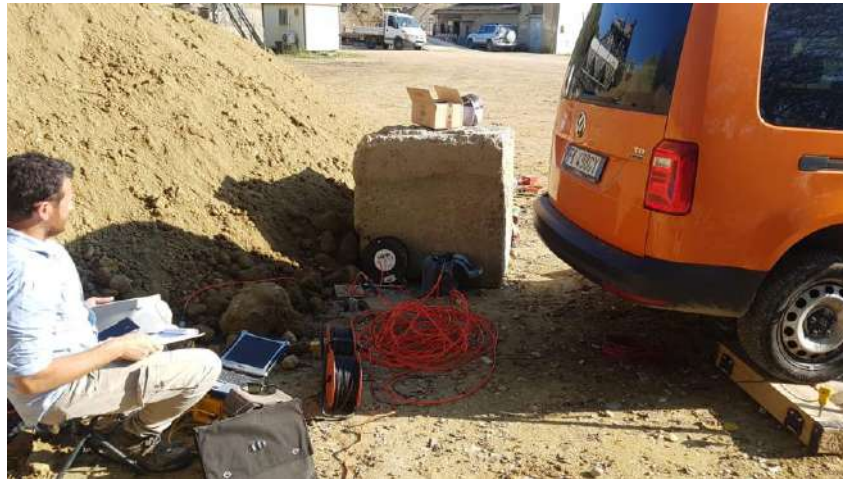
Fase di acquisizione indagine Down Hole.
