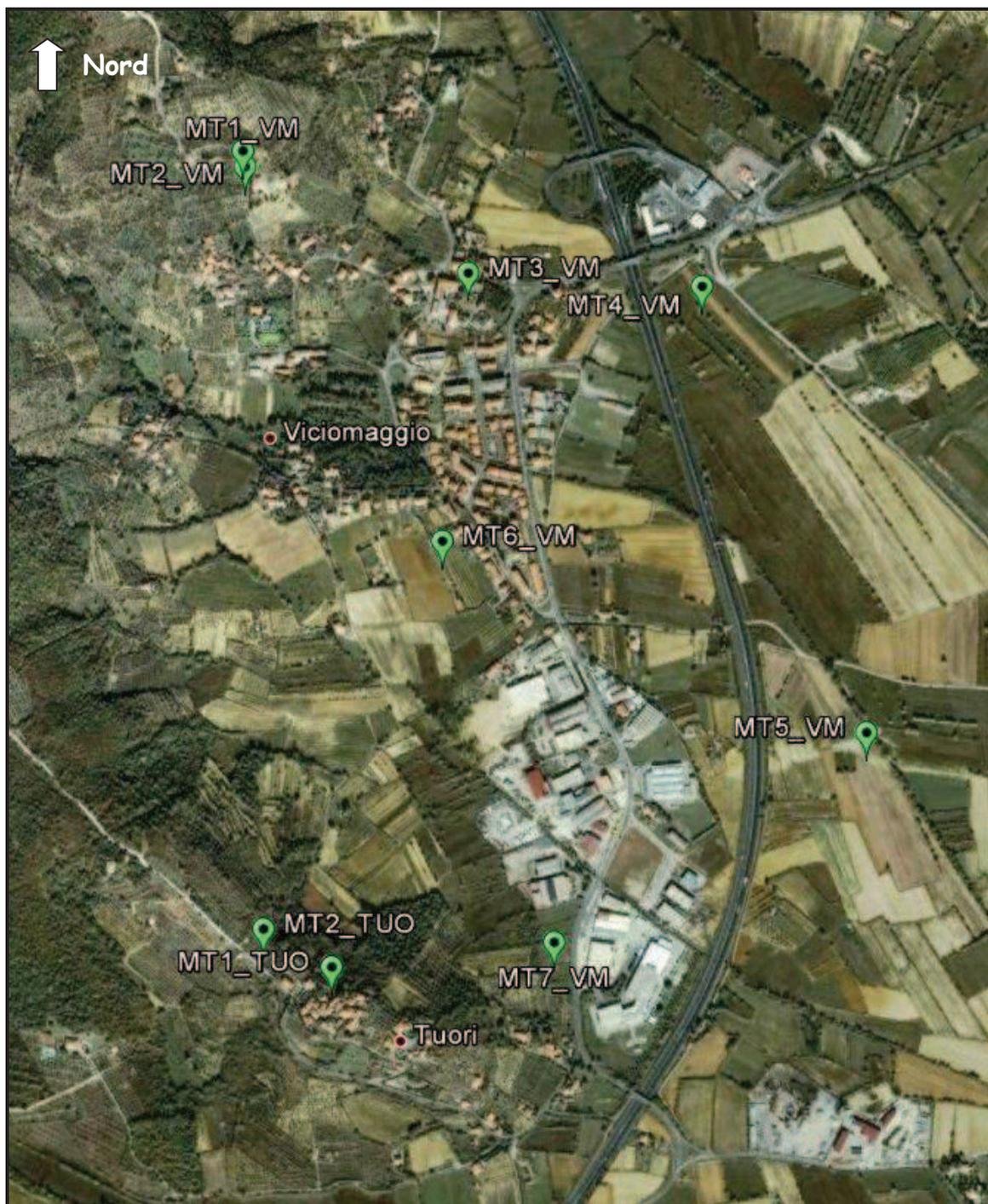
Figura 9 - Ubicazione misure 'HVSr' effettuate in località Vicinaggio e Tuori (AR).
